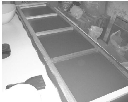
Figura 6 - Molde para a confecção dos CPs: compensado, plástico e madeira envernizada
