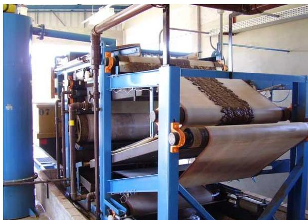
Figura 3.11 – Filtro prensa de esteira em operação (Catálogo EnvironQuip, 2010).
