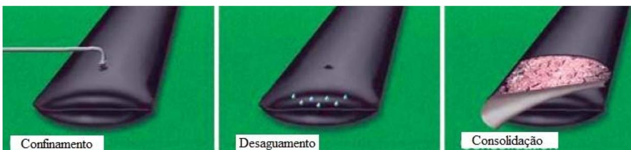
Figura 3.8 – Operação do sistema de desaguamento de lodos em bags de geotêxtil (Watersolve, LLC, 2006, apud USEPA 2006, modificado).
