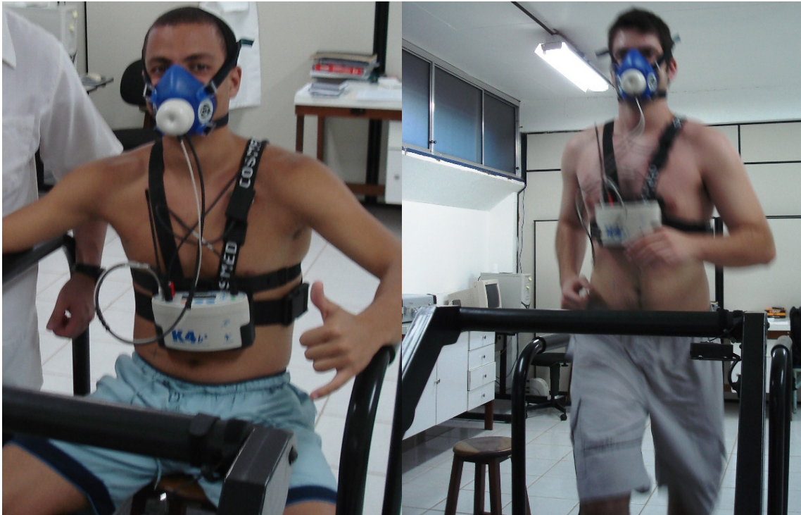
FIGURA 2 - Calorímetro portátil acoplado ao voluntário para a realização da ergoespirometria em esteira rolante
