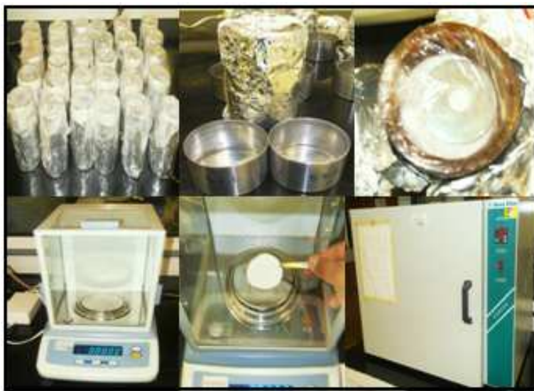
Figura 3.19 – Procedimentos utilizados no ensaio de sucção.
