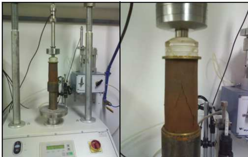
Figura 3.21 – Ensaio de resistência a compressão simples
