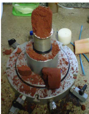
Figura 4.42 – Ruptura das amostras MP2 com adição de fibras.
