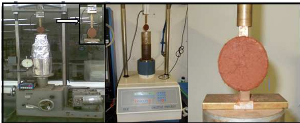
Figura 3.20 – Pressas automáticas e aplicação de tensões no ensaio de tração.
