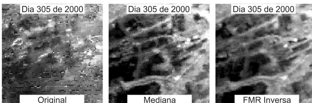
**Fig. 4.5** - Qualidade crescente das imagens referentes ao dia 305 do ano de 2000, original (esquerda), após o filtro de mediana (centro) e após a transformação inversa FMR (direita).
