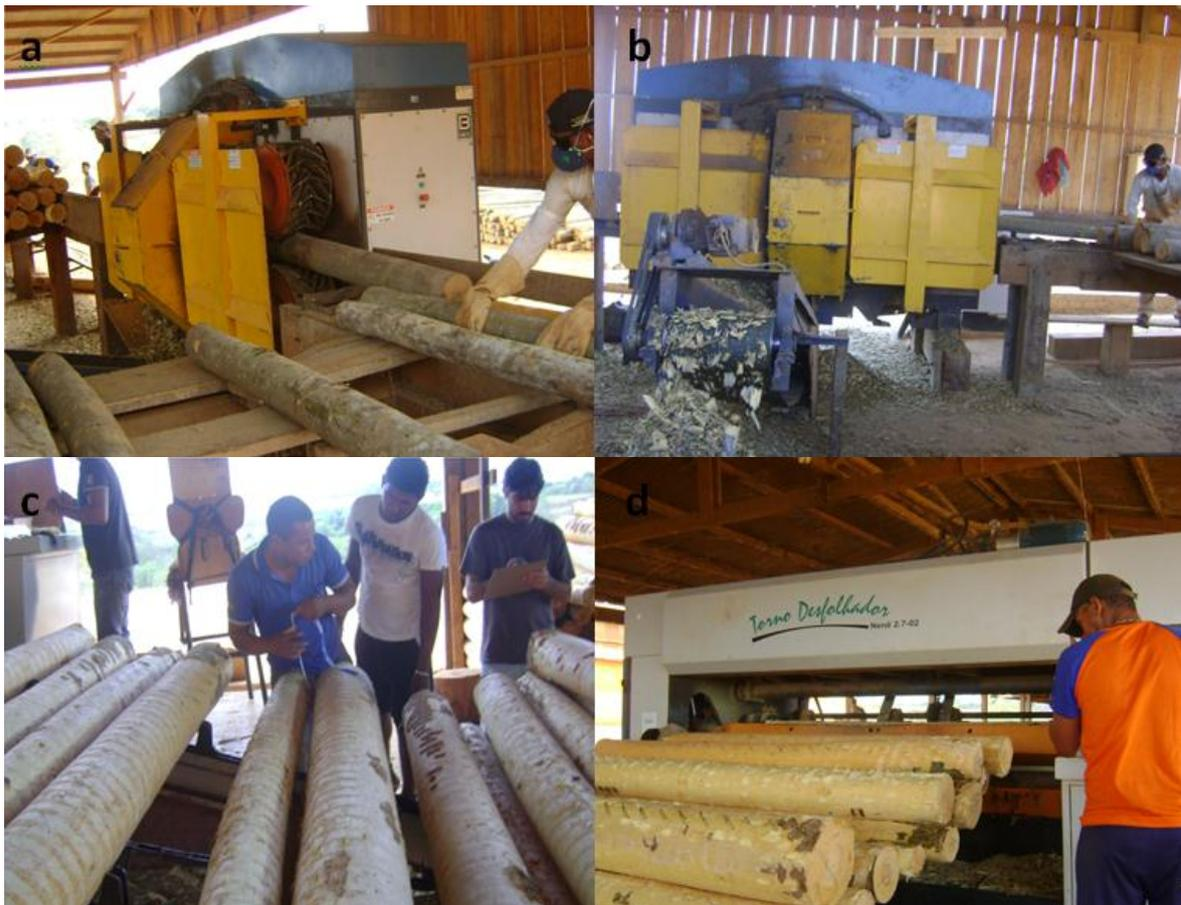
**Figura 3** - Processo de descascamento das toras (a e b); tomada de medidas nas toras sem casca (c) e; torno desfolhador utilizado no processo de laminação (d).
