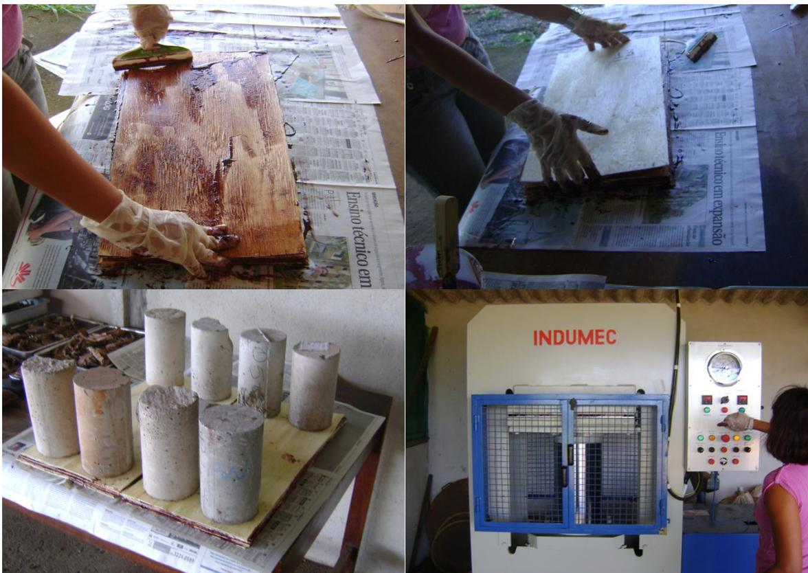
**Figura 3.** Aplicação do adesivo, montagem e prensagens a frio e quente dos painéis LVL produzidos com paricá.
