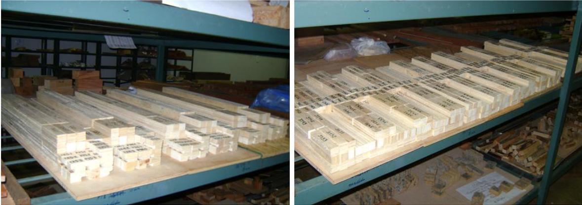
**Figura 3.** Climatização das amostras utilizadas nos ensaios físicos e mecânicos.
