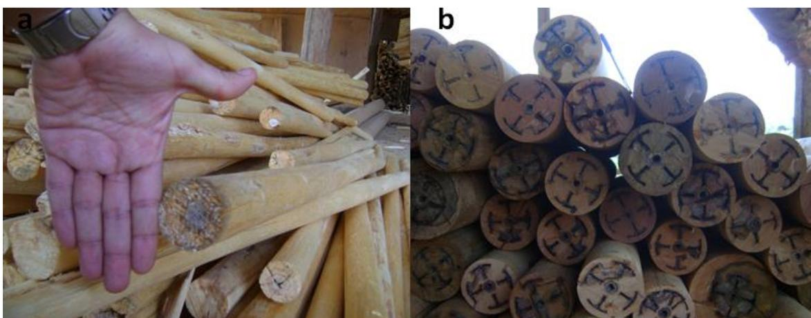
**Figura 7.** Comparações entre rolos resto – paricá laminados em tornos com fusos tracionados (a) e outras espécies nativas laminadas em tornos com garras de fixação (b).
