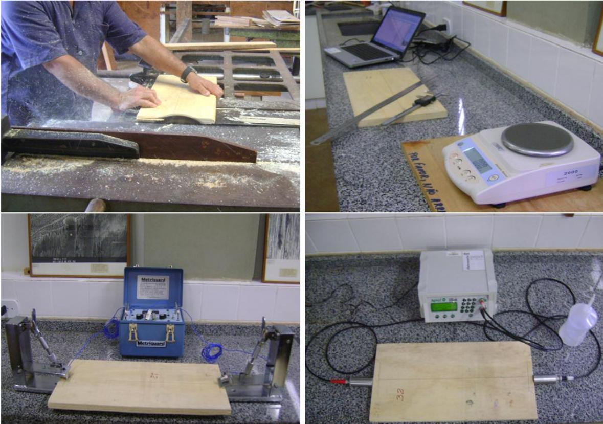
**Figura 1.** Esquadrejamento dos painéis (a), obtenção das dimensões e massa dos painéis (b), determinação da velocidade de propagação das ondas utilizando *Stress Wave* (c) e ultrassom (d).
