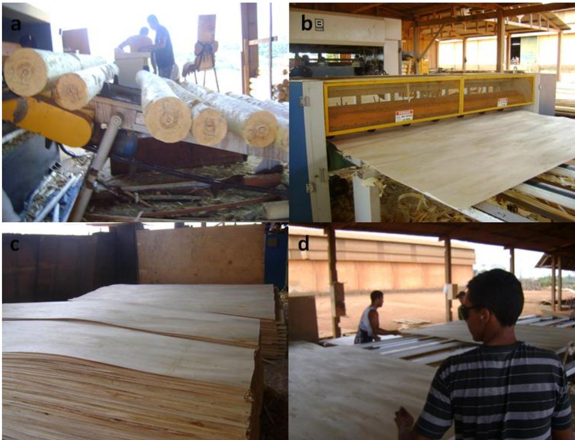
**Figura 4** - Disposição das toras em sequência na esteira do torno laminador (a); processo de laminação do paricá (b); lâminas produzidas nas diferentes dimensões (c) e; contabilização do total de lâminas produzido por cada tora (d).
