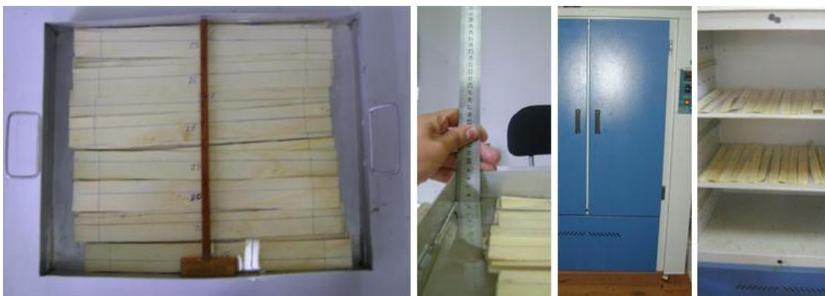
**Figura 2.** Saturação e secagem das lâminas para determinação da estabilidade dimensional
