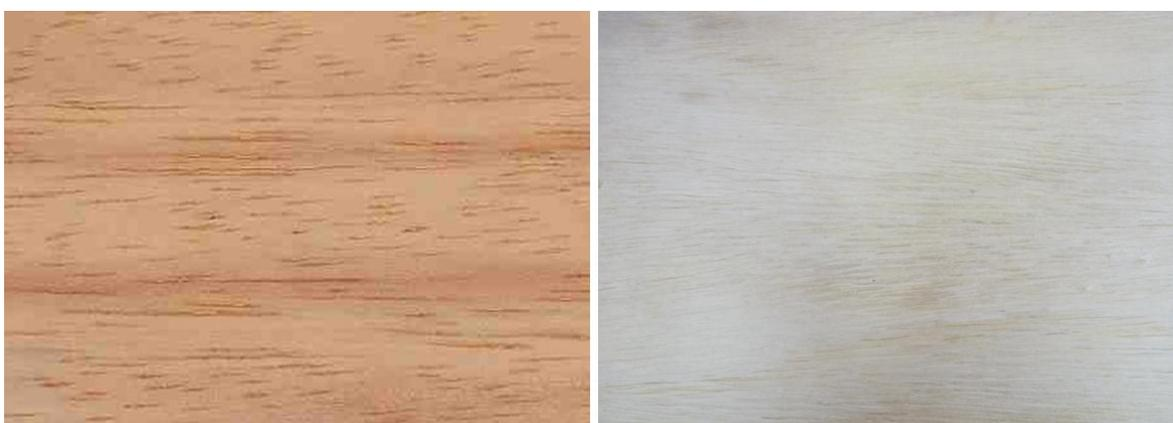
**Figura 5.** Diferenciação de cor entre cerne - madeira (LPF, 2012) e alburno - lâmina.
