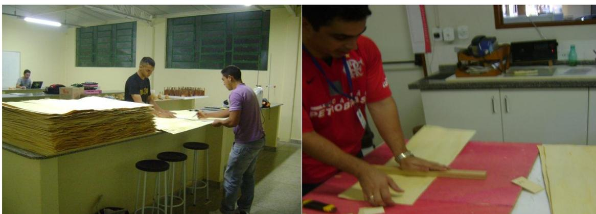
**Figura 1.** Redimensionamento e seleção das lâminas.
