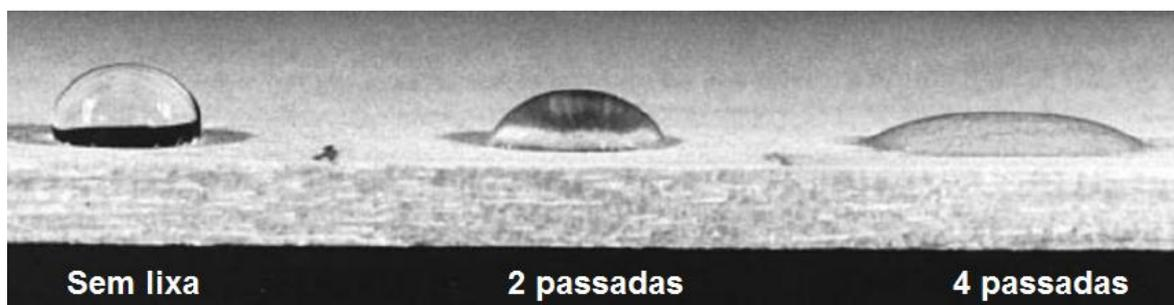
**Figura 12.** Imagem de gotas 30 segundos após serem colocadas na superfície de uma lamina de madeira com diferentes tratamentos superficiais (USDA, 2010).
