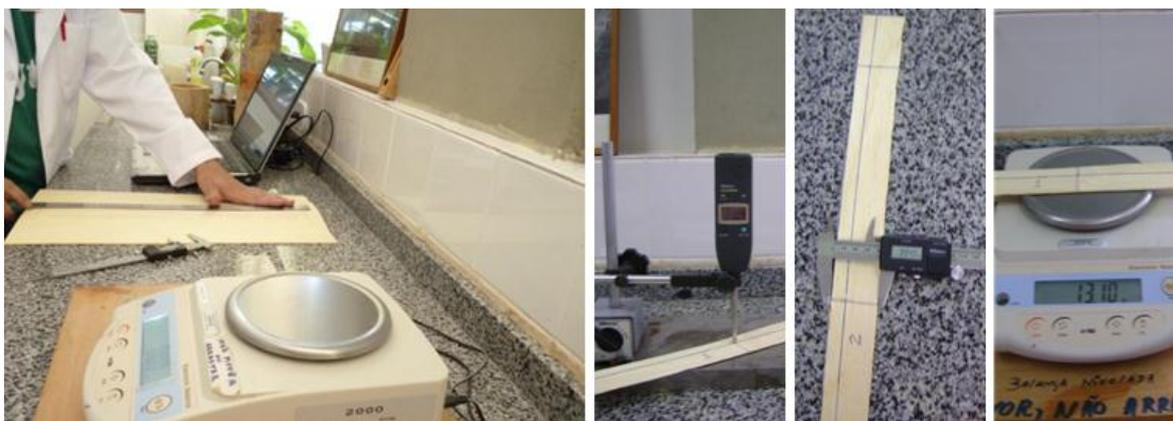
**Figura 1.** Obtenção das dimensões e massa das amostras para determinação das propriedades físicas das lâminas de paricá.
