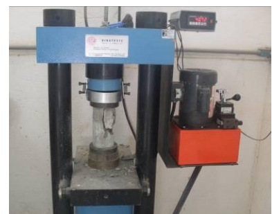
Ruptura do cilindro
