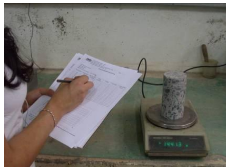
Determinação da massa depois de 72h de imersão
