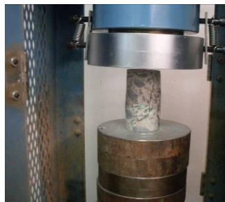
Ensaio de Resistência à compressão
