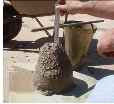
Determinação da consistência pelo abatimento do tronco de cone
