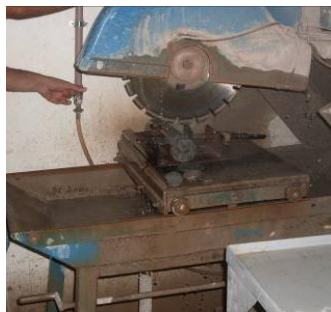
Corte dos testemunhos h/d=2 .
