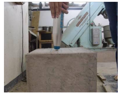
Medição do índice esclerométrico no prisma
