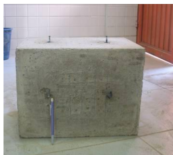
Prisma ensaiado nas diferentes fases
