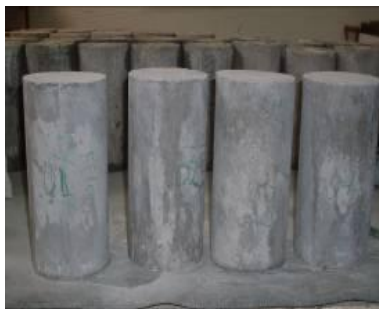
Cilindros retirados da câmara úmida
