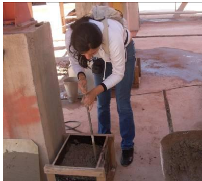
Adensamento manual nos corpos-de-prova
