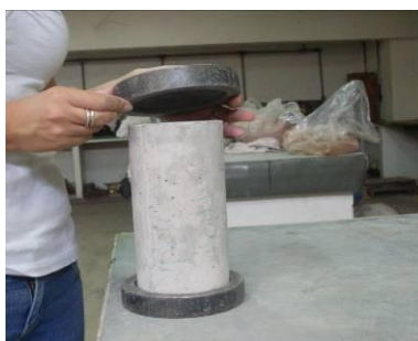
Capecamento com almofada de neoprene confinada
