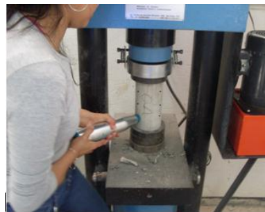
Medição do índice esclerométrico no cilindro
