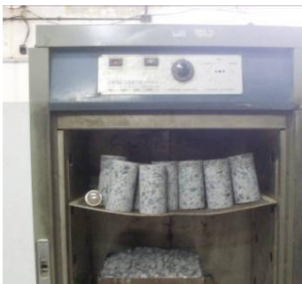
Testemunhos submetidos a secagem em estufa
