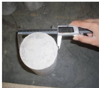
Medida de diâmetro e comprimento
