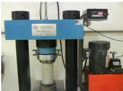
Fixação do cilindro com carregamento de 1000 Kg
