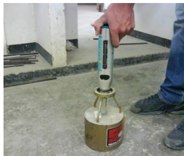
Calibração do equipamento com a bigorna
