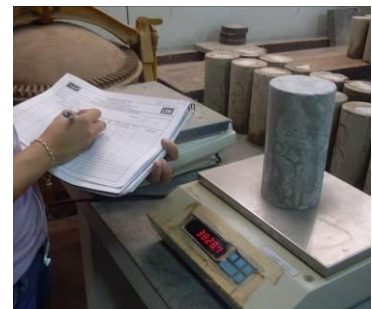
Determinação da massa do cilindro
