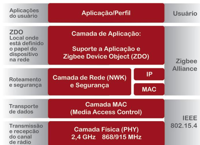
Figura 2.6: Camadas do Padrão Zigbee (adaptado de (Faludi, 2010)).
