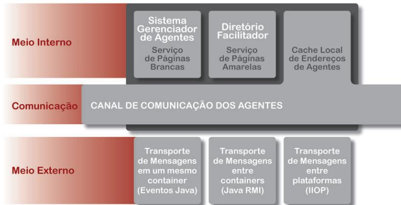
Figura 3.9: Interoperabilidade em JADE (adaptado de Bellifemine et al. (2007)).
