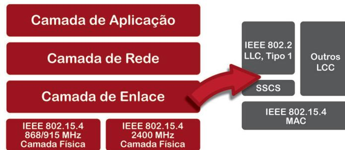
Figura 2.4: Camadas do Padrão *Zigbee* (adaptado de (Faludi, 2010)).
