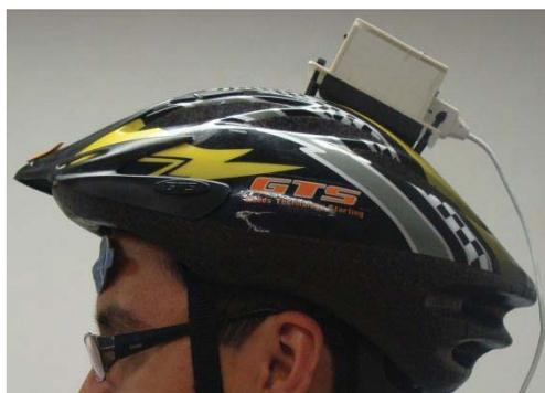
Figura 4.2. Protótipo de hardware ligado ao capacete do ciclista.
