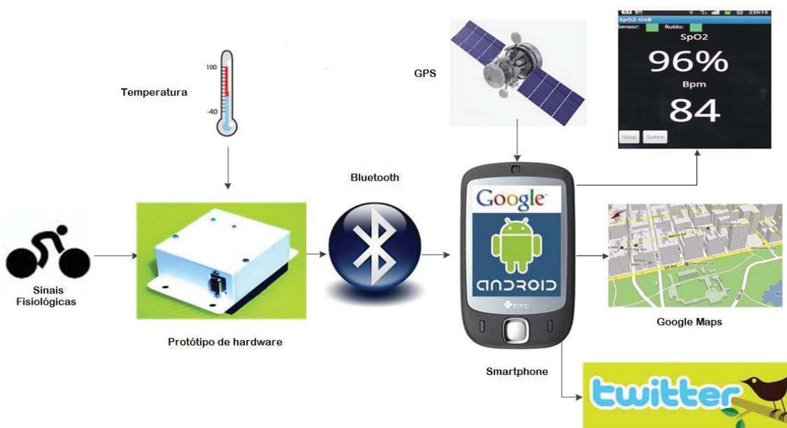
Figura 3.24. Diagrama do protótipo e o aplicativo no smartphone para o monitoramento e treinamento de ciclistas.
