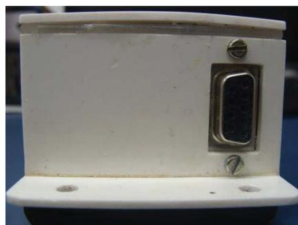
Figura I.3. Conector DB9 para o sensor de testa.
