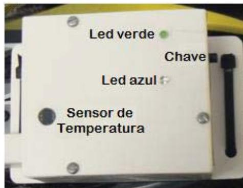
Figura I.2. Módulo hardware do sistema de monitoramento e treinamento de ciclistas.
