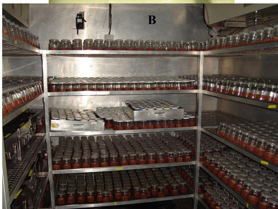
Figura 5.1 Detalhe dos frascos de vidro contendo solo corrigido e placa suporte (A). Câmara climática durante período de incubação dos frascos de vidro (B).
