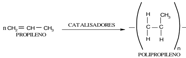
Figura 2.7. Reação geral da polimerização do propileno.
