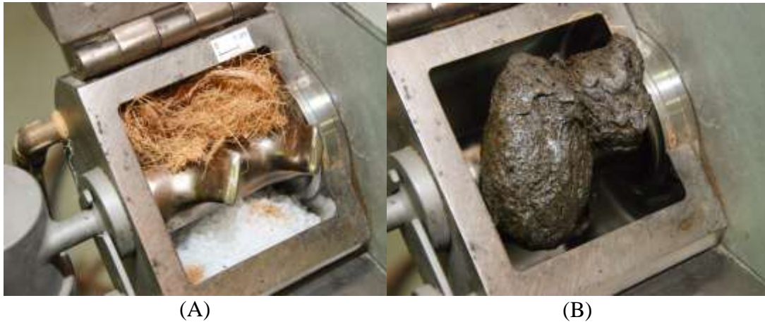
Figura 4.8. A) Fibra de coco e o polipropileno antes da mistura; B) compósito (fibra de coco + PP) no misturador termocinético.
