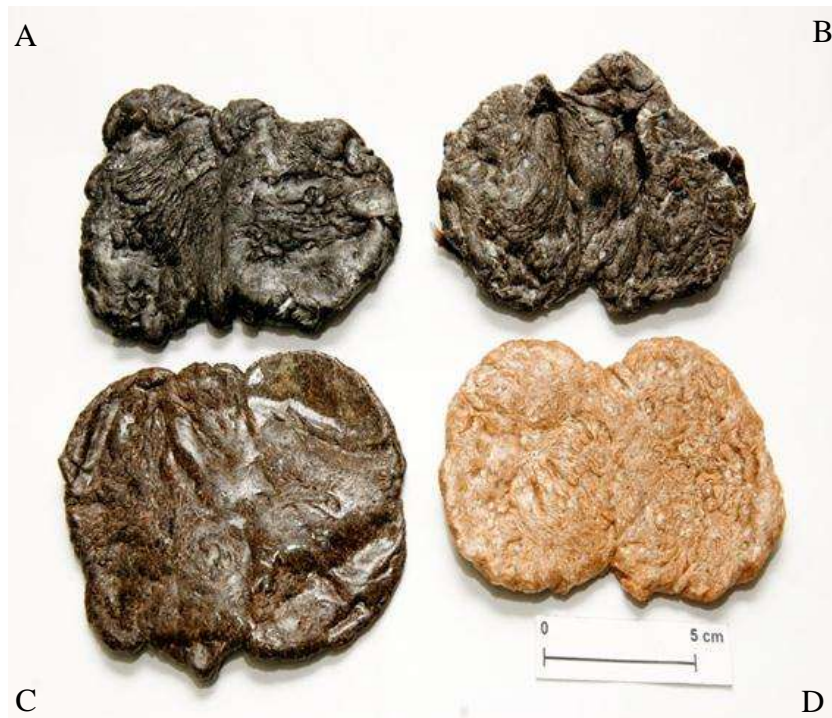
Figura 4.9. Compósitos de fibra de coco 10% (m/m)/ PP antes da moagem: fibras in natura (A), fibra tratada com água quente a 80°C (B), fibra tratada com solução de NaOH 2% (m/v) (C) e fibra tratada com sequência (D).
