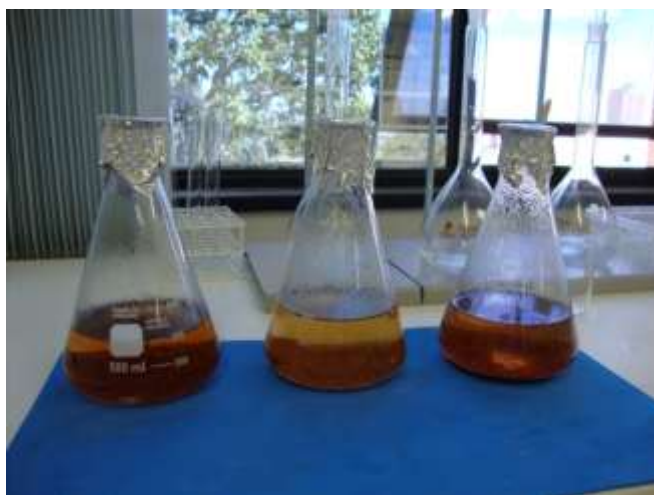
Figura 4.1. Substâncias obtidas após a hidrólise ácida da fibra de coco.
