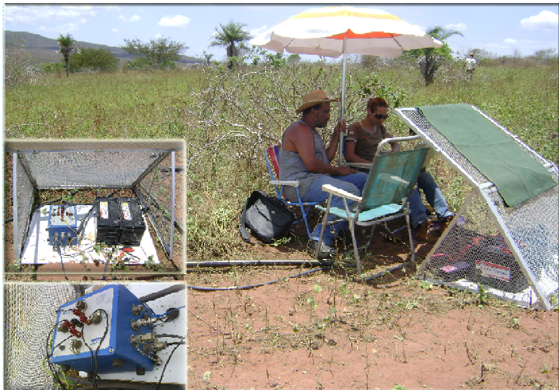
Figura 4.1.6. Programação de aquisição dos dados. Detalhe os cabos de conexão entre eletrodos, magnetômetros e o sistema central (estação Metronix GSM06).
