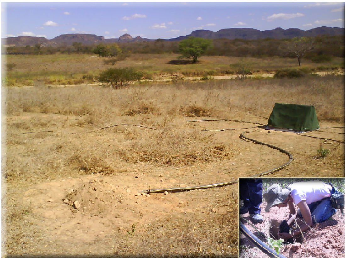
Figura 4.1.4. Instalação de magnetômetro vertical. Detalhe para o nivelamento do magnetômetro.
