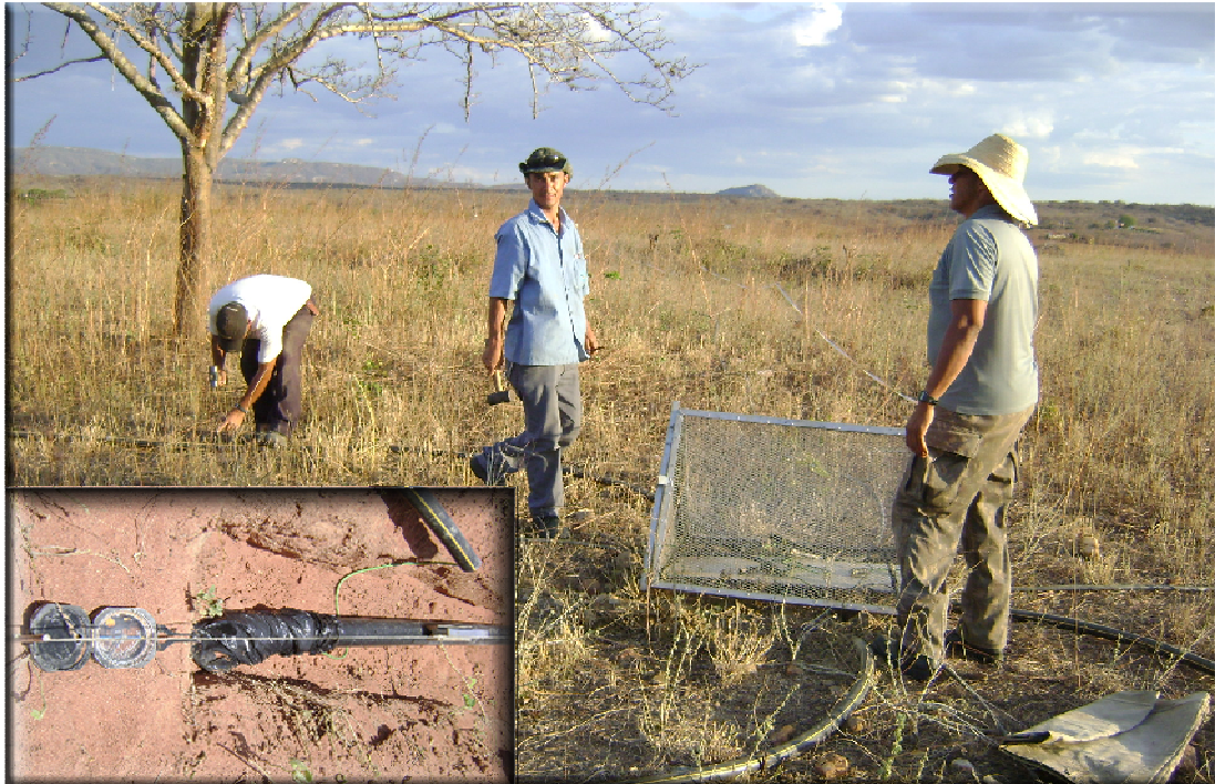
Figura 4.1.3. Instalação de magnetômetro horizontal. Detalhe para o alinhamento do magnetômetro com o auxílio de bússola e linha de referência feita com barbante e estacas.
