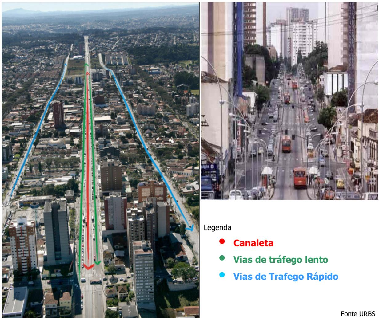
Figura 2.17 – Sistema Trinário - Eixos Estruturais e as Vias de Tráfego Lento e Rápido
