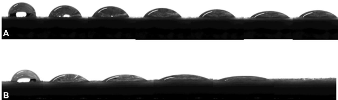
FIGURA 3.5 – Imagens da gota d'água na superfície da lâmina de amescla no lado sem as fendas (A) e no lado com as fendas (B).
