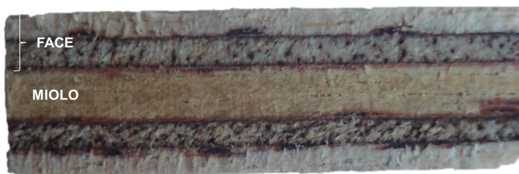
FIGURA 2.1 – Seção transversal do painel compensado com cinco lâminas.
