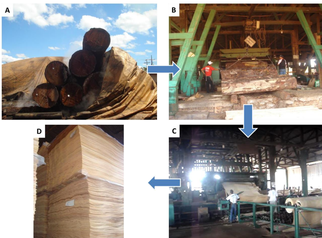
FIGURA 3.1 – Sequência de produção das lâminas. A) toras de amescla durante o cozimento. B) toras entrando no torno desenrolador. C) saída das lâminas do torno. D) lâminas separadas por qualidade.
