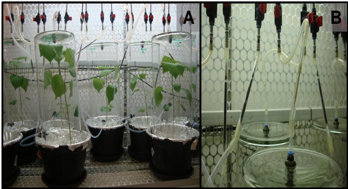
Figura 8. Sistema push-pull de coleta de voláteis de plantas de algodão no estágio vegetativo. A. Visão geral. B. Detalhe para os tubos de vidro contendo o polímero adsorvente Super Q.
