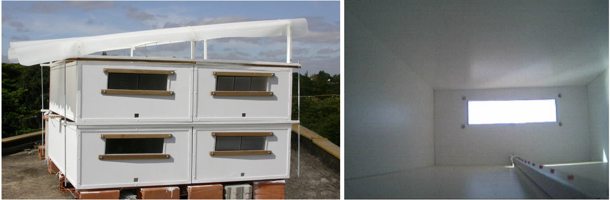
Figura 4.1 e 4.2: Exemplo de protótipo elaborado para o estudo da luz natural. Vista exterior e vista interior. Fonte: CIAMPINI, 2005.
