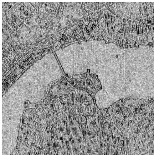
Figura 4.11 – Imagem complexa da correlação entre os canais  $L_{HH}$  e  $L_{VV}$ .
