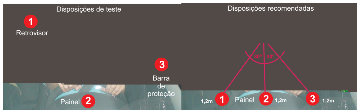
Figura 4.13: Posicionamento recomendado para o sistema de captura de vídeo e da iluminação IVP dentro do veículo.
