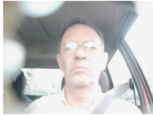
(b) Captura diurna com luz solar incidente, sem filtro IVP, disposição de captura no painel atrás do volante.
