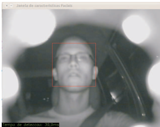
(c) Detecção do rosto em tempo real com o condutor usando óculos comum, em horário noturno (22 h 25 min), o sistema de captura e iluminação IVP 850 nm localizado na parte frontal painel (atrás do volante).
