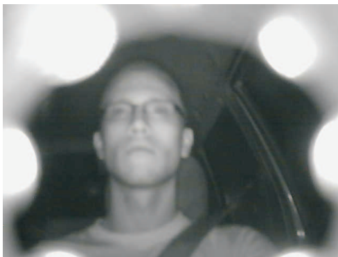
(c) Captura noturna com iluminação e filtro IVP de 950 nm, disposição de captura no painel atrás do volante.
