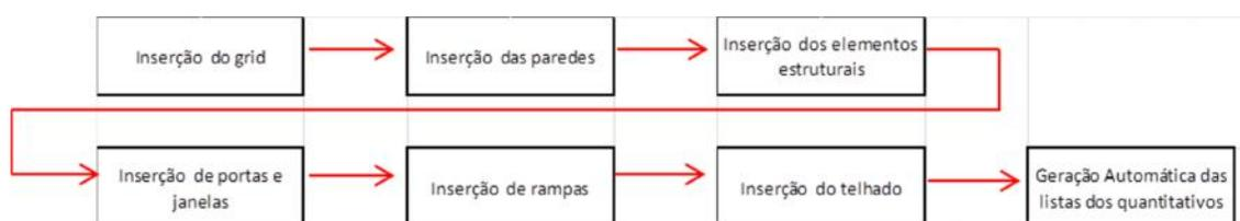
A figura acima ilustra as tarefas que foram executadas para modelagem da edificação e posterior extração dos quantitativos. O modelo pode ser visualizado na Figura 19, abaixo.
