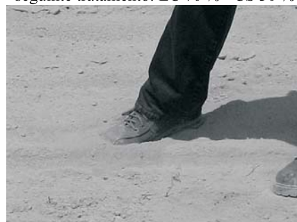
Excesso de material solto com baixa coesão, observado nos trechos com os seguintes tratamentos: LC 50 % - CS 50 % e LC 70 % - CS 30 %
