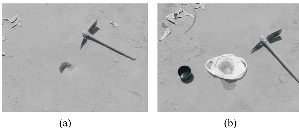
Figura 2 – Aspectos gerais (a) e sacola plástica preenchida com água (b) nos orifícios para a determinação da densidade específica aparente seca nos trechos experimentais.
