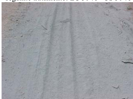
Trilhas de roda com médio nível de severidade, presentes nos trechos com os seguintes tratamentos: LC 50 % - CS 50 % e LC 70 % - CS 30 %
