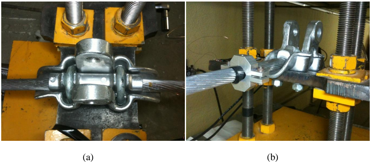
Figura 3.12 – (a) Vista superior da montagem cabo/grampo (b) Vista frontal da montagem cabo/grampo [37]
