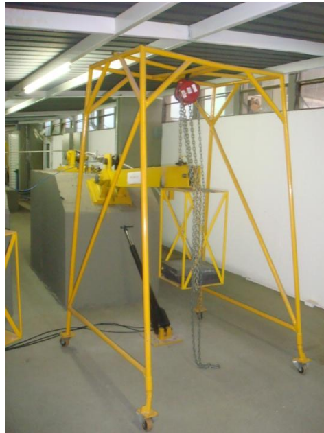
Figura 3.9 - Bloco fixo 3 que contém os equipamentos para controle de tração do cabo.
