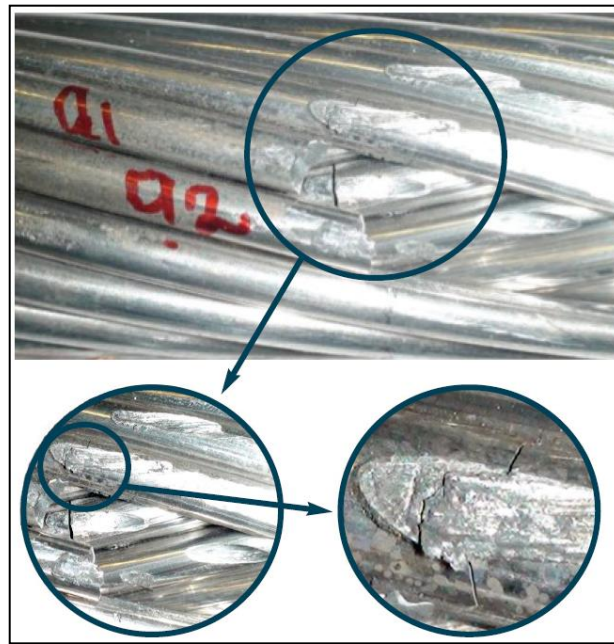
Figura 2.14 —Marcas de fretting e falhas nos fios de alumínio do de um cabo ACSR após ensaio de fadiga. Detalhe para o arrancamento de material no contato mais severo do fio com a base do grampo [12].
