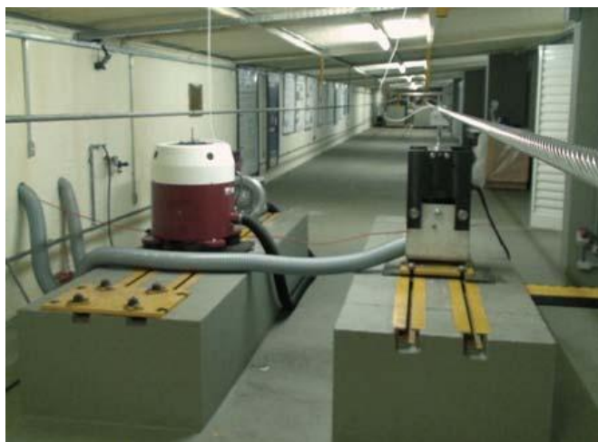
Figura 3.7 – Blocos fixos com o trilho para deslocamento do shaker .
