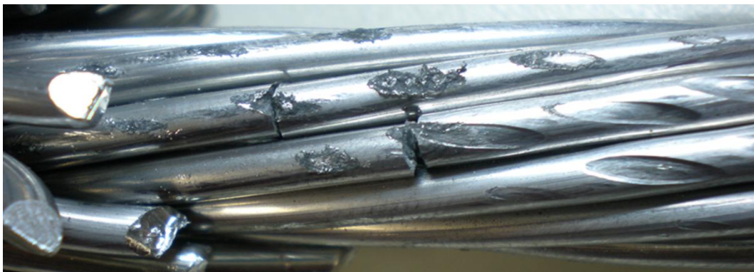
Figura 4.12 – Marcas de fretting , amassamento e desgaste na região de falha.
