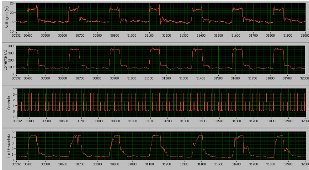
Figura 4.1: Amostra de sinais adquiridos. Os gráficos mostram na sequência de cima para baixo respectivamente os sinais de tensão e de corrente de soldagem, de pulsos de controle da câmera e de intensidade de luz ultravioleta emitida.
