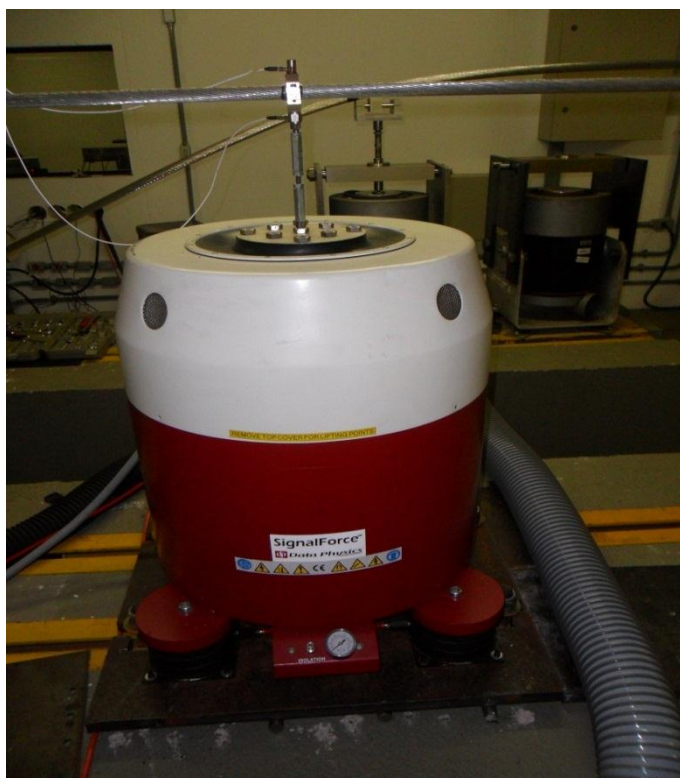
Figura 3.2. Shaker acoplado a um cabo condutor.
