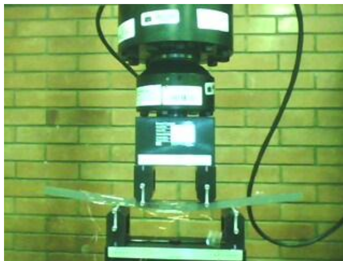
Figura 3.8: Ensaio de flexão com a barra de SMA.
