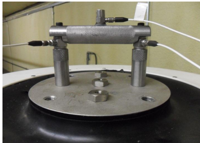
Figura 3.4 Suporte montado no shaker .
