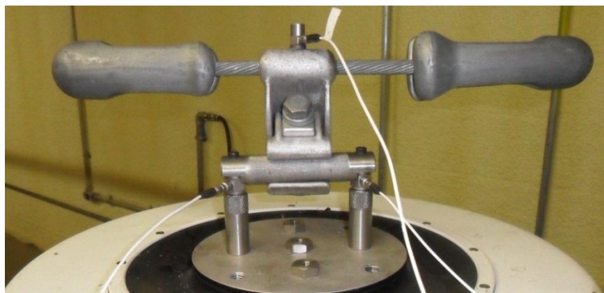
Figura 3.27. Montagem do absorvedor stockbridge assimétrico.
