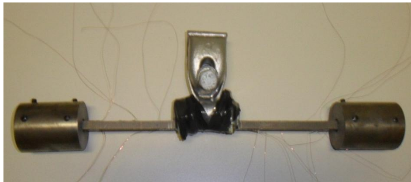
Figura 3.16. Protótipo II com grampo de fixação.
