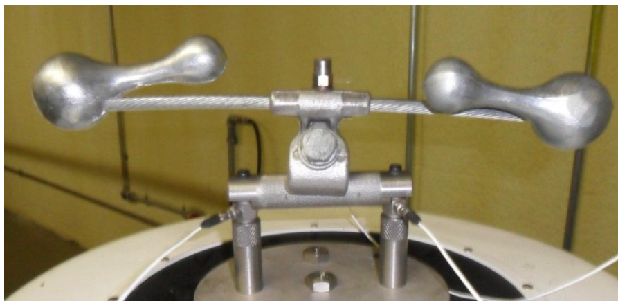
Figura 3.28. Montagem do absorvedor stockbridge dogbone F4000.
