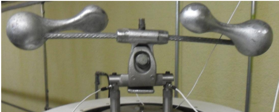
Figura 3.30. Montagem do absorvedor stockbridge dogbone F4000-08.
