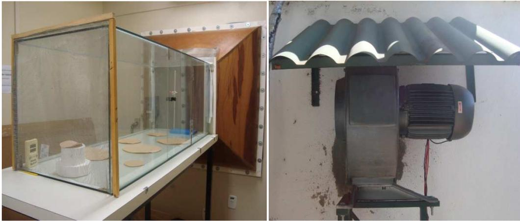
Fig. 1.7 – Túnel de vento (esquerda) e seu motor (direita)
