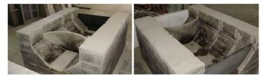
Figura 2.13 - Protótipo de barragem construída para estudo dinâmico(Sevim et al., 2010)
