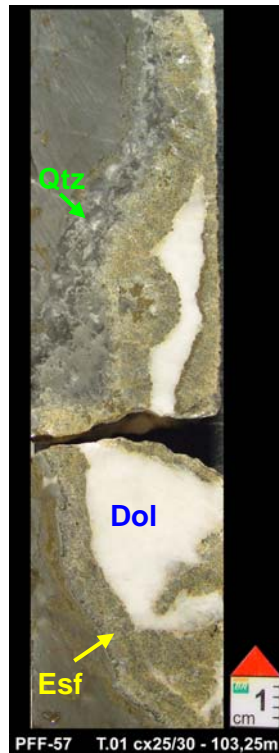
Figura nº253 Detalhe da fratura preenchida por quartzo (Qtz - seta verde) e dolomita (Dol). Profundidade 103,25m.
