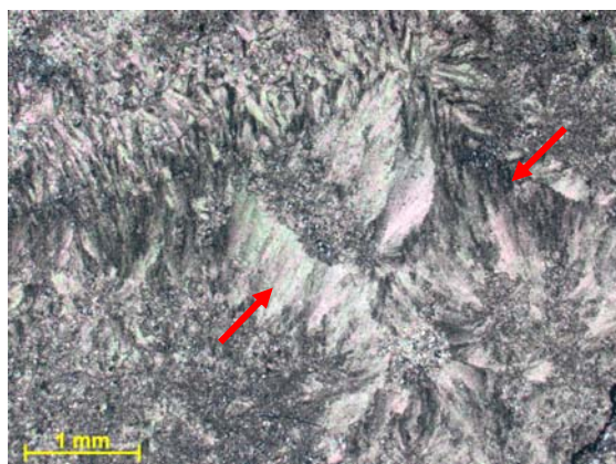
Figura nº195 Detalhe da dolomita fibro-radial, tratando-se provavelmente de cimentação calcítica marinha dolomitizada. Fotomicrografia, PX. Profundidade: 39,75m.
