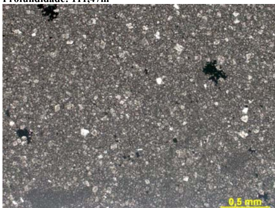
Figura nº208 Detalhe de dolomita fina a muito fina em dololuto. Fotomicrografia, P//. Profundidade: 91,20m.
