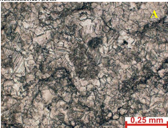
Figura nº136 A - Detalhe do calcarenito intensamente recristalizado. Fotomicrografia, P//. B - Imagem de catodoluminescência. Mesma visada da foto A. Notar segundo processo de recristalização ocorrendo de forma pervasiva, gerando cristais mais luminescentes (seta). Profundidade:236,67m.
