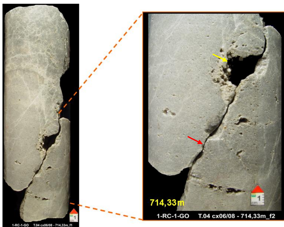
Figura nº60 Foto de detalhe mostrando fratura aberta (seta vermelha) com porosidade vugular associada (seta amarela). Notar que a dissolução ocorreu de forma mais intensa ao longo do plano da fratura e nas suas proximidades. Profundidade: 714,33m.
