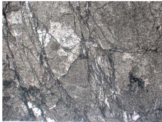
Figura nº252 Detalhe da rocha intensamente fraturada. Fotomicrografia, P//. Profundidade: 49,14m.
