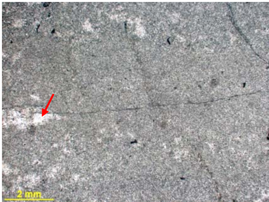
Figura nº162 Seta indicando porosidade cimentada na fácies de dololuto. Fotomicrografia, P//. Profundidade: 11,05m.
