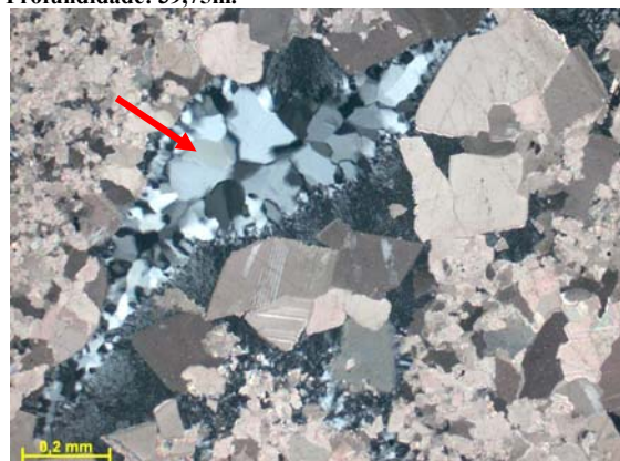
Figura nº182 Seta indicando cimentação por sílica (calcedônia nas bordas e quartzo no centro) e dolomita. Fotomicrografia, P//. Profundidade: 25,18m.
