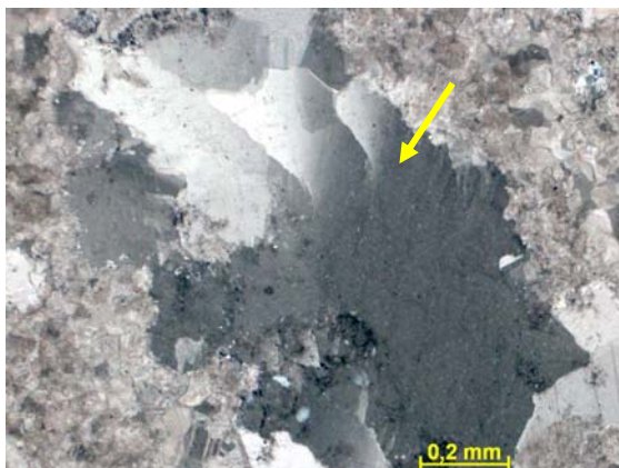
Figura nº144 Detalhe da dolomita-em-sela cimentando porosidade secundária. Fotomicrografia, PX. Profundidade: 239,53m.
