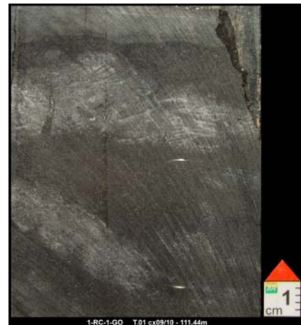
Figura nº110 Foto de detalhe da fácies de calcirrudito intraclástico. Testemunho 1. Profundidade: 111,44m.
