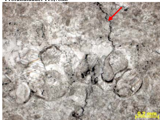
Figura nº122 Detalhe do estilolito subvertical. Fotomicrografia, P//. Profundidade: 109,95m.
