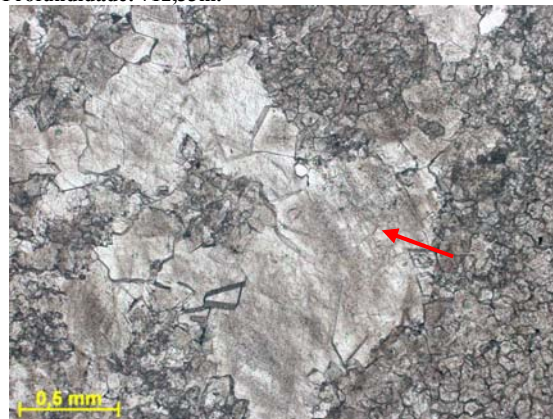
Figura nº76 Detalhe do cimento dolomítico de cristalinidade muito grossa. Fotomicrografia, P//. Profundidade: 716,68m.
