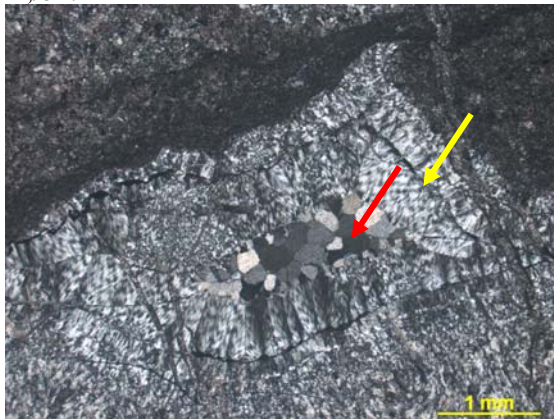
Figura nº227 Detalhe de várias fases de cimentação de sílica. Seta amarela indicando níveis de calcedônia e seta vermelha indicando quartzo. Fotomicrografia, PX. Profundidade: 44,02m.
