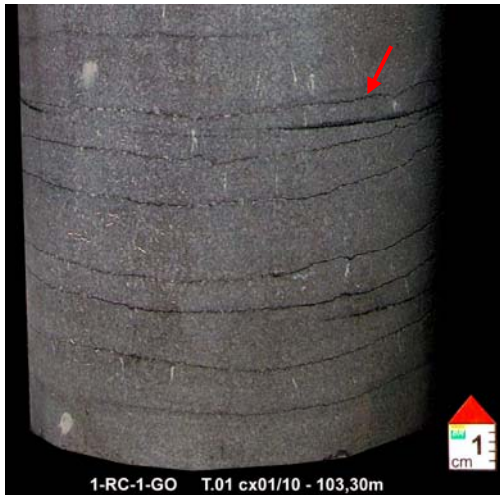
Figura nº117 Detalhe dos estilolitos horizontais, paralelos ao acamamento. Foto de detalhe. Profundidade: 103,30m.
