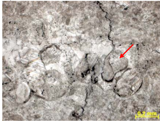
Figura nº93 Detalhe dos grãos oolíticos concentrados em pequena porção da rocha. Fotomicrografia, P//. Profundidade: 109,95m.
