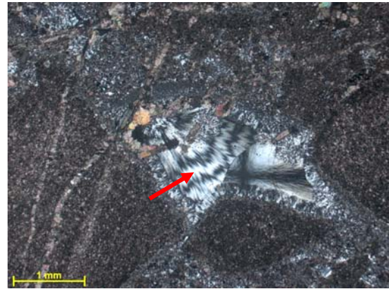
Figura nº187 Detalhe da cimentação por sílica (calcedônia) entre os fragmentos carbonáticos. Fotomicrografia, PX. Profundidade: 8,75m.
