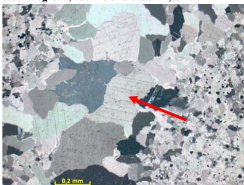
Figura nº213 Detalhe da cimentação por dolomita (cristais mais grossos). Fotomicrografia, PX. Profundidade: 25,18m.
