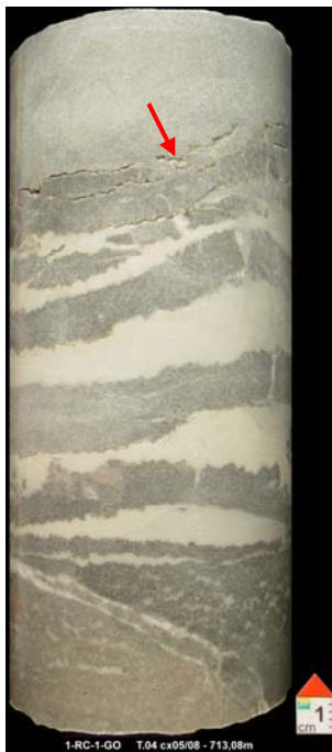
Figura nº53 Foto de detalhe mostrando estilolitos subhorizontais. Profundidade: 713,08m.
