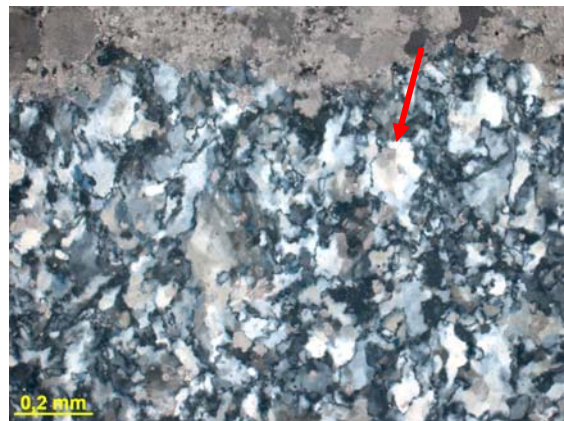
Figura nº218 Detalhe dos cristais de quartzo que ocorrem substituindo parcialmente a rocha. Notar a forma irregular dos cristais. Fotomicrografia, PX. Profundidade: 44,02m.
