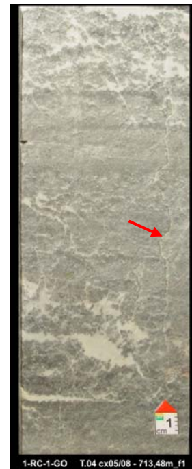
Figura nº55 Foto de detalhe mostrando estilolitos vertical. Profundidade: 713,48m.
