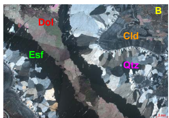
Figura nº256 Detalhe da cimentação na fratura. Da borda para o centro ocorre sílica (calcedônia - Cld e posteriormente quartzo - Qtz), esfalerita - Sph e por último dolomita - Dol. A - Fotomicrografia, P//. B - Fotomicrografia, PX (mesma visada da foto A), Profundidade: 51,25m.
