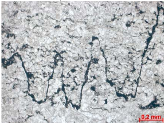
Figura nº119 Detalhe do estilolito no contato entre as litologias. Fotomicrografia, P//. Profundidade: 236,67m.
