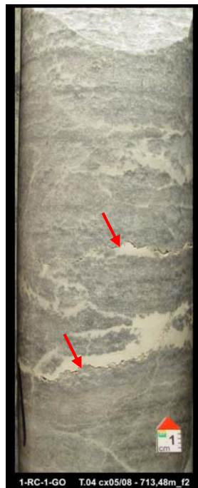
Figura nº54 Foto de detalhe mostrando estilolitos subhorizontais no contato entre cavidades preenchidas por sedimento fino e a matriz da rocha. Profundidade: 713,48m.
