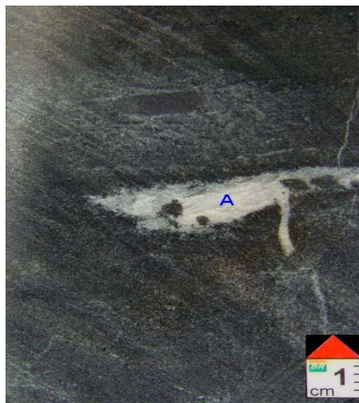
Figura nº152 Foto de detalhe dos pontos onde foram coletadas amostras para análise isotópica. A - Cimento; B - Matriz. Testemunho 1. Profundidade: 111,63 m
