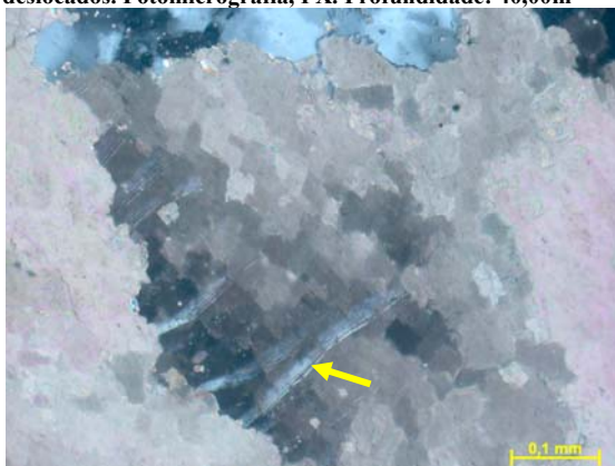
Figura nº239 Cristais de dolomita apresentando o início da formação de subcristais. Seta indicando resquício da antiga clivagem do cristal. Fotomicrografia, PX. Profundidade: 30,70m.
