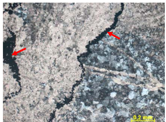
Figura nº235 Setas indicando planos de estilólitos com concentração de cristais de pirita. Fotomicrografia, PX. Profundidade: 39,75m.
