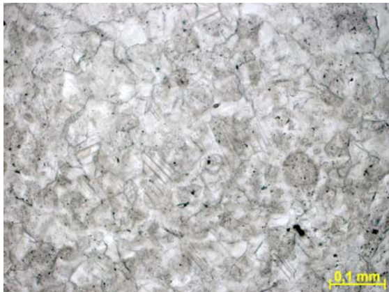
Figura nº131 Detalhe do calcarenito recristalizado. Fotomicrografia, P//. Profundidade 108,33m.
