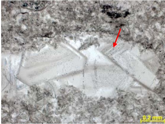
Figura nº127 Seta indicando cristais de calcita cimentando porosidade secundária. Fotomicrografia, P//. Profundidade: 109,95.
