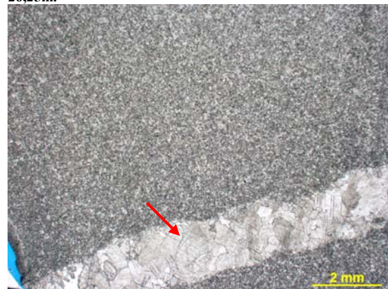
Figura nº165 Seta indicando fratura cimentada por dolomita na fácies de dololuto. Fotomicrografia, P//. Profundidade: 90,70m.
