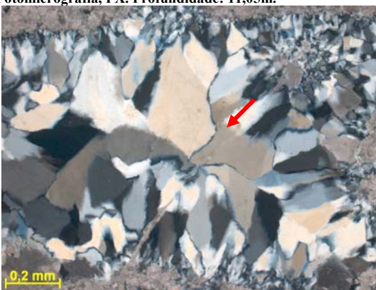
Figura nº248 Seta indicando cimentação por sílica. Os cristais crescem da borda em direção ao centro do poro. Fotomicrografia, PX. Profundidade: 42,86m.
