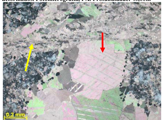
Figura nº240 Seta vermelha indicando cimento dolomítico com cristais de pirita nas bordas e seta amarela indicando zona de cisalhamento com cristais de dolomita alongados. Fotomicrografia, PX. Profundidade: 41,92m.
