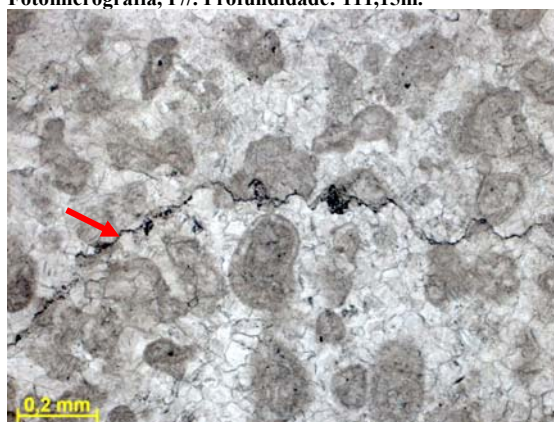
Figura nº86 Observar contatos flutuantes e pontuais entre os grãos, indicando que a cimentação por calcita ocorreu na eodiagenese, visto que não há compactação dos grãos. Seta indicando estilolito, mostrando que a compactação química ocorreu após a cimentação. Fotomicrografia, P//. Profundidade: 111,41m.
