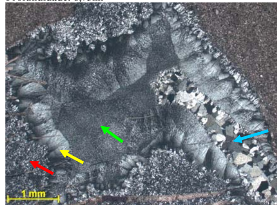
Figura nº189 Detalhe do cimento de sílica apresentando várias fases de crescimento. Seta vermelha indicando microquartzo (primeira fase), seta amarela indicando calcedônia (segunda fase), seta verde indicando microquartzo (terceira fase) e seta azul indicando quartzo (última fase de cimentação). Fotomicrografia, PX. Profundidade: 9,25m.
