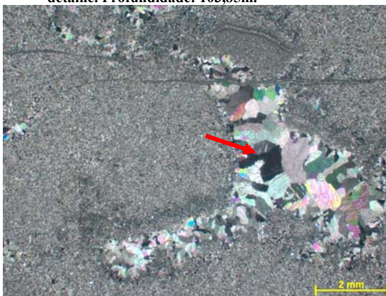
Figura nº246 Seta indicando porção da rocha aonde os cristais de dolomita apresentam cristalinidade muito grossa, tratando-se possivelmente de porosidade cimentada. Fotomicrografia, PX. Profundidade: 11,05m.
