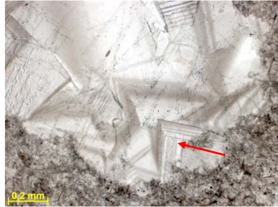
Figura nº128 Detalhe dos cristais zonados de calcita blocosa cimentando porosidade vugular. Fotomicrografia, P//. Profundidade: 109,95m.
