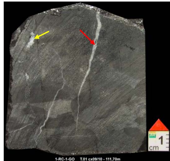
Figura nº124 Seta vermelha indicando fratura subvertical cimentada por calcita. Seta amarela indicando porosidade secundária do tipo vugular cimentada por calcita. Foto de detalhe. Profundidade: 111,70m.
