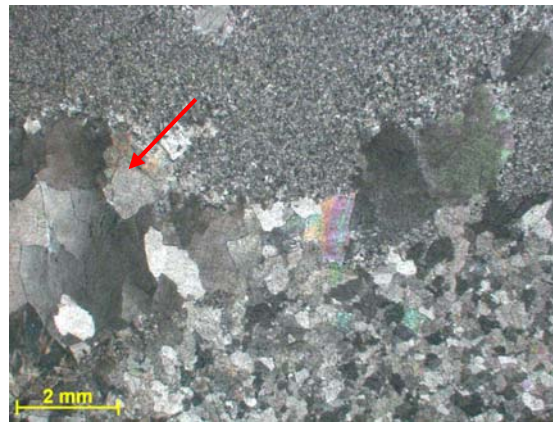
Figura nº74 Seta indicando cimento de dolomita-em-sela. Fotomicrografia, polarizadores cruzados (PX). Profundidade: 712,33m.
