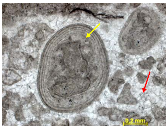
Figura nº113 Detalhe de oolito com núcleo de intraclasto carbonático (seta amarela). Seta vermelha indicando cimento calcítico do tipo mosaico grosso. Fotomicrografia, P//. Profundidade 111,41m.
