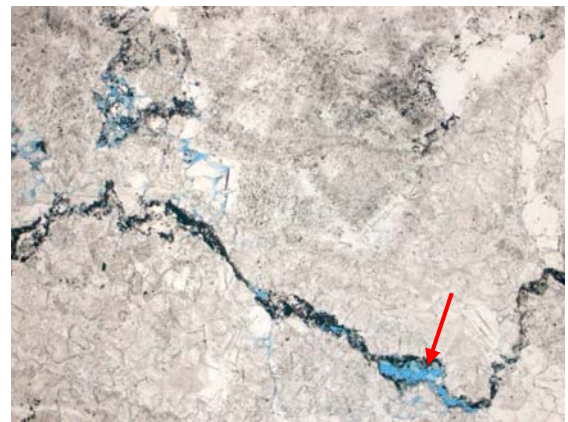
Figura nº141 Seta indicando porosidade secundária ao longo de plano de estilolito. Fotomicrografia, P//. Profundidade: 111,15m.
