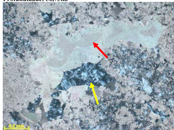
Figura nº172 Seta indicando cimento dolomítico com forma botrioidal e cor mais escura. Cristais límpidos de dolomita crescem posteriormente como sobrecrecimento, e seta amarela indicando cimentação por calcedônia. Mesma visada da figura 170. Fotomicrografia, PX. Profundidade: 36,16m.
