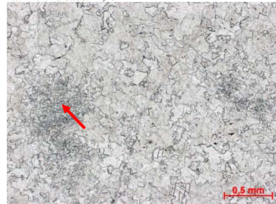
Figura nº207 Detalhe dos cristais de dolomita com bordas irregulares. Seta indicando porção com cristais mais finos. Fotomicrografia, P//. Profundidade: 38,92m.
