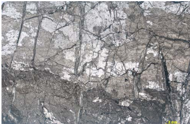
Figura nº251 Detalhe da rocha intensamente fraturada. Fotomicrografia, P//. Profundidade: 48,75m.
