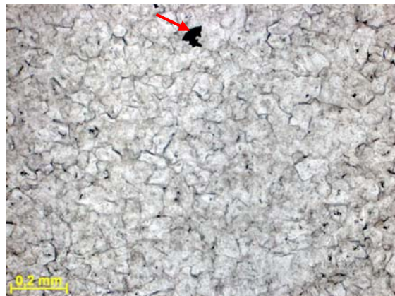
Figura nº26 Detalhe do dolerudito intensamente recristalizado. Seta indicando pirita. Fotomicrografia, P//. Profundidade: 716,68m.
