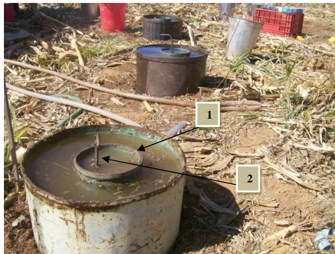
Figura 1. Teste com infiltrômetros de anéis, demonstrando em (1) o anel interno de onde se determinava a taxa de infiltração e em (2) o micrômetro para a leitura das lâminas infiltradas
