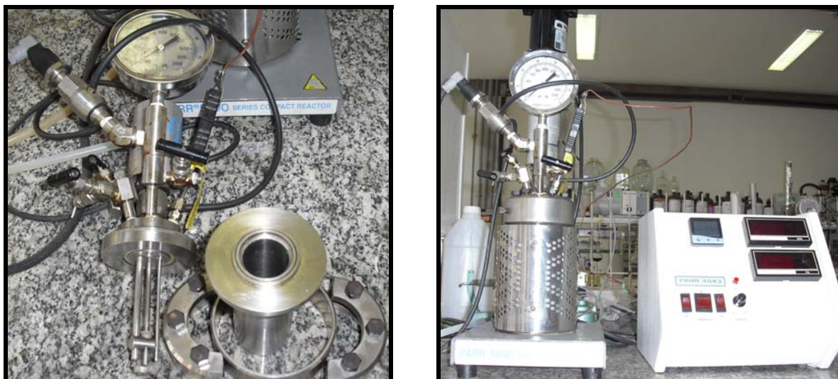
Figura 8. Reator e controlador utilizados nos experimentos catalíticos.
