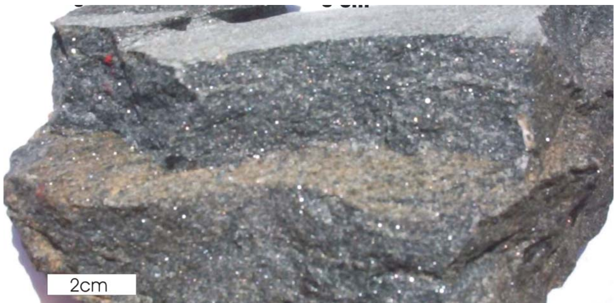
Figura 3.19 – Aspecto macroscópico do anfibolito com granulação fina e foliação definida por cristais de hornblenda e biotita.
