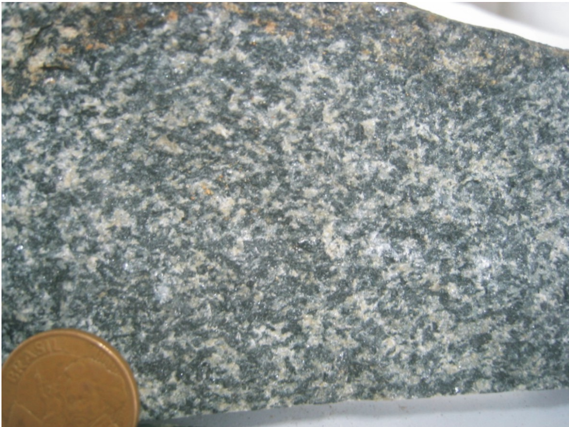
Figura 3.32 – Aspecto macroscópico do metadiorito com granulação média a grossa e foliação discreta definida por hornblenda xenoblástica.
