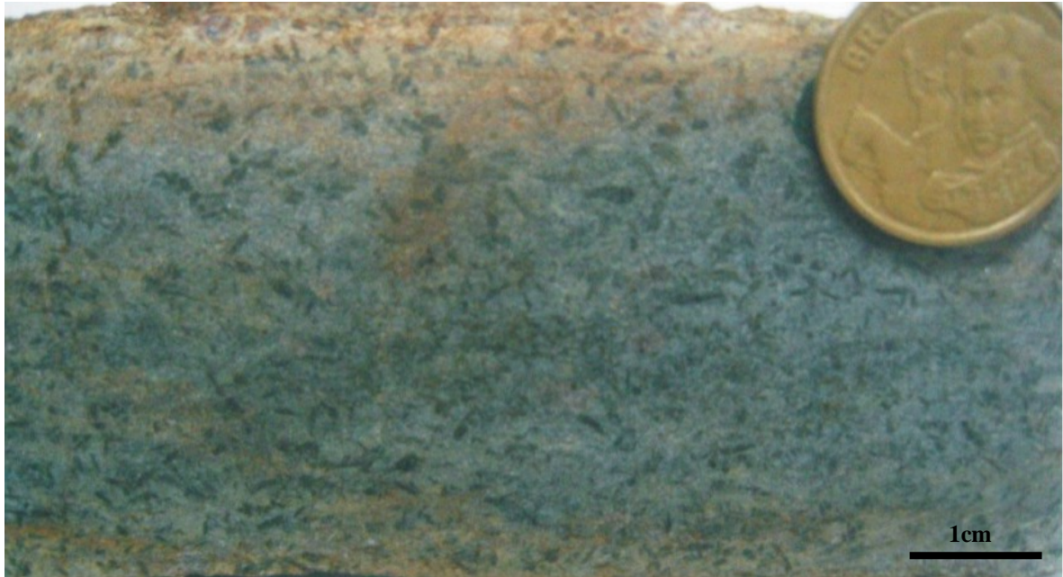
Figura 3.26 – Aspecto macroscópico do quartzo-muscovita-hornblenda xisto, com porfiroblastos diablásticos de hornblenda.
