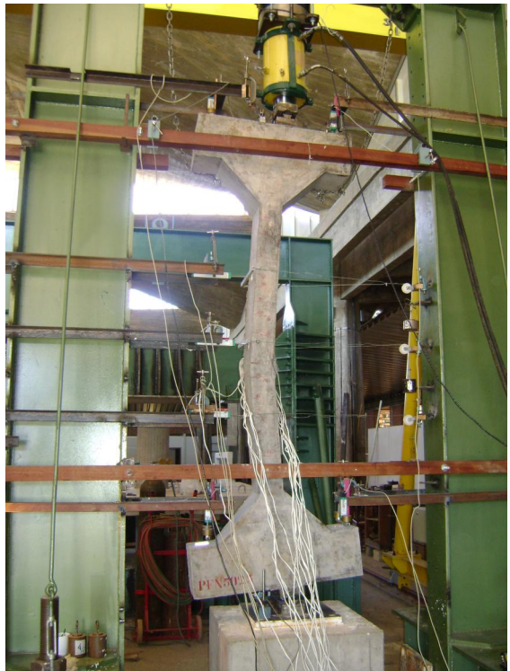
Figura 4.41 – Ruína do pilar PFN 50-2,5
