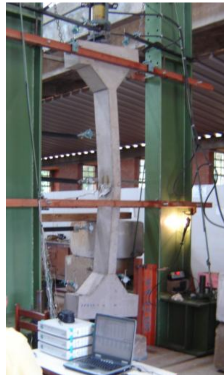
Figura 4.33 – Ruína do pilar PFN 40-3
