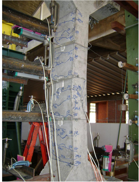
Figura 4.47 – Ruína do pilar PFN 40-2
