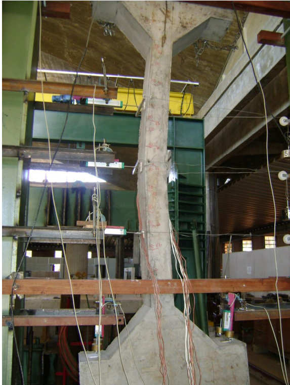
Figura 4.42 – Ruína do pilar PFN 60-2,5
