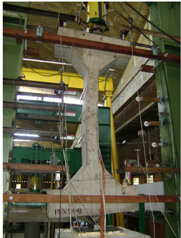
Figura 4.45 – Ruína do pilar PFN 24-2
