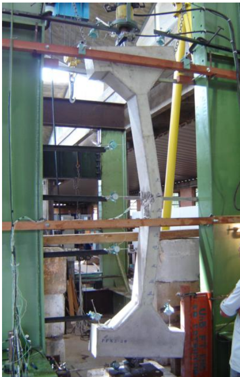
Figura 4.32 – Ruína do pilar PFN 30-3
