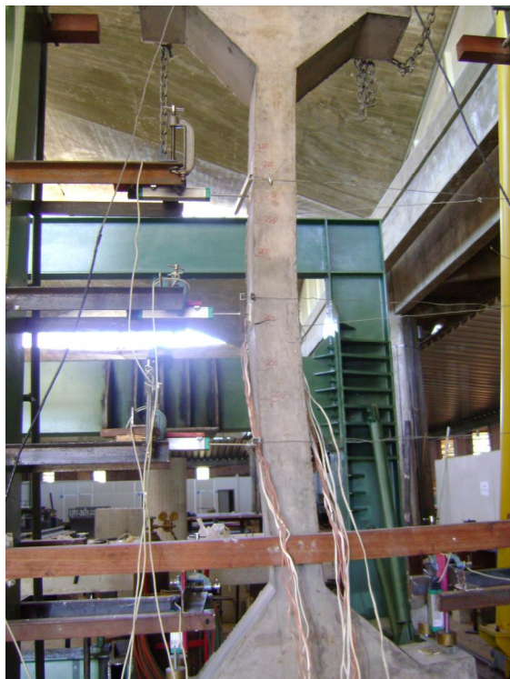
Figura 4.40 – Ruína do pilar PFN 40-2,5
