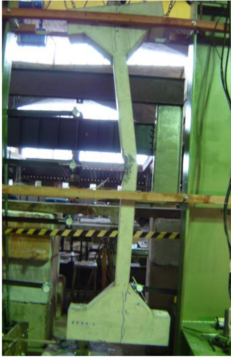
Figura 4.26 – Ruína do pilar PFN 0-3
