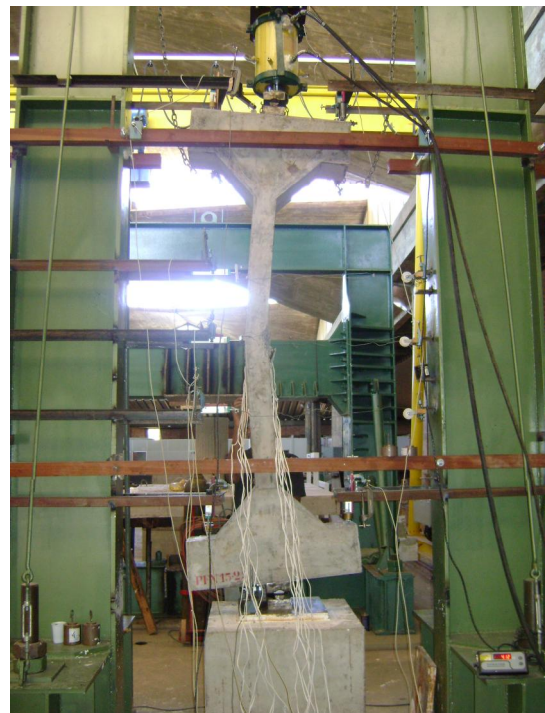
Figura 4.37 – Ruína do pilar PFN 15-2,5
