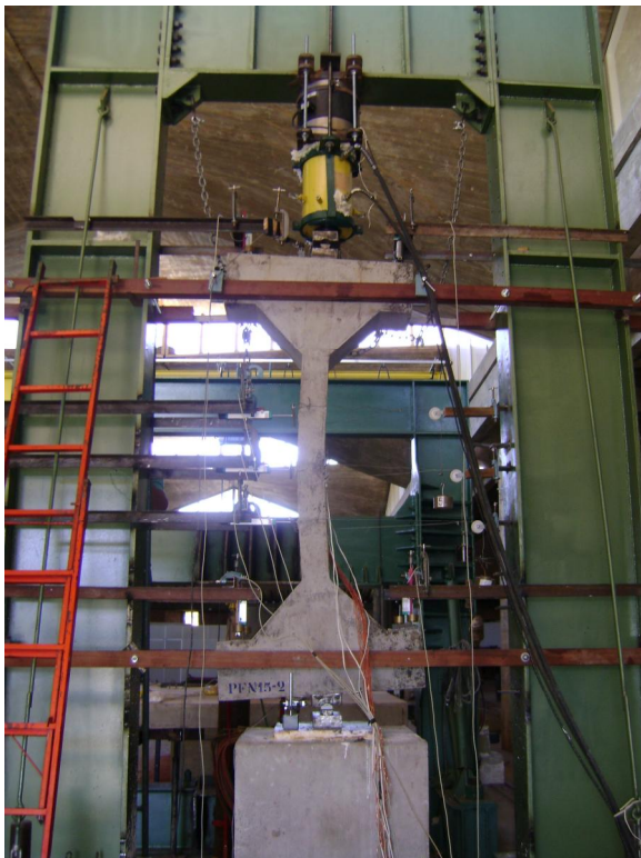
Figura 4.44 – Ruína do pilar PFN 15-2
