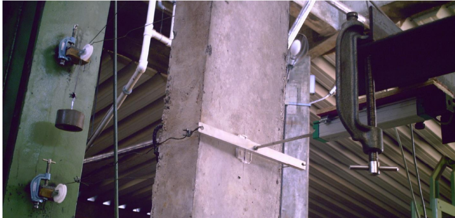
Figura 3.18 – Sistema de pesos e roldanas para a garantia de contato haste/pilar
