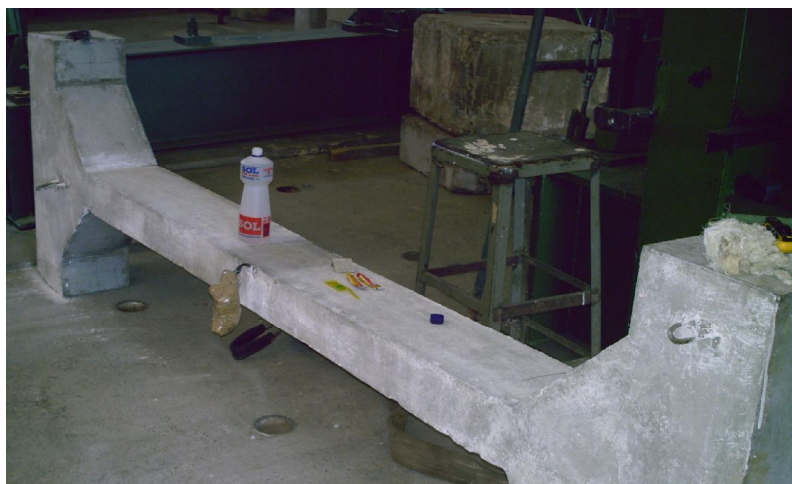
Figura 3.15 – Posicionamento adotado do pilar para colagem dos extensômetros
