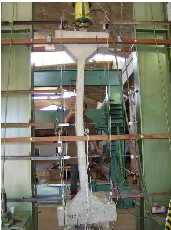
Figura 4.28 – Ruína do pilar PFN 12-3
