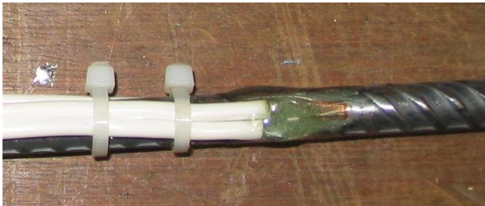
Figura 3.9 – Extensômetro colado e protegido com ARALDITE
