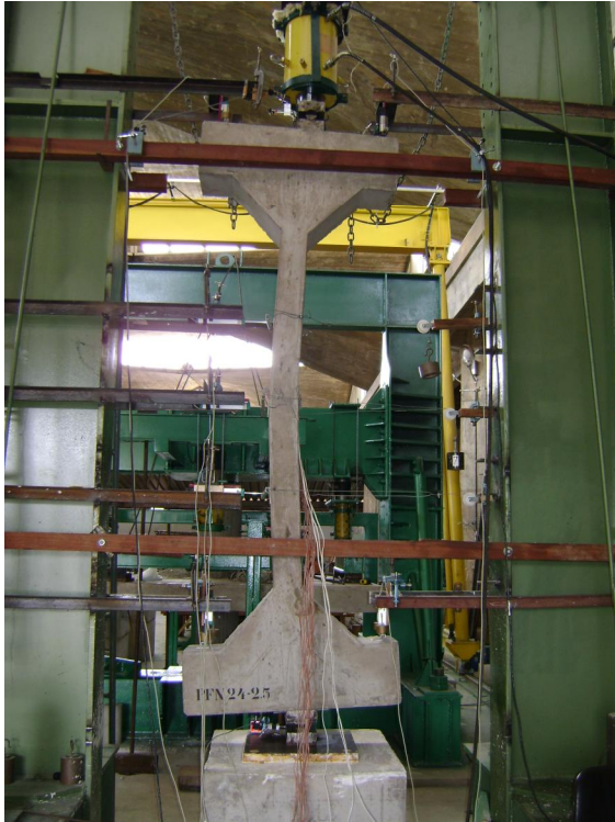
Figura 4.38 – Ruína do pilar PFN 24-2,5
