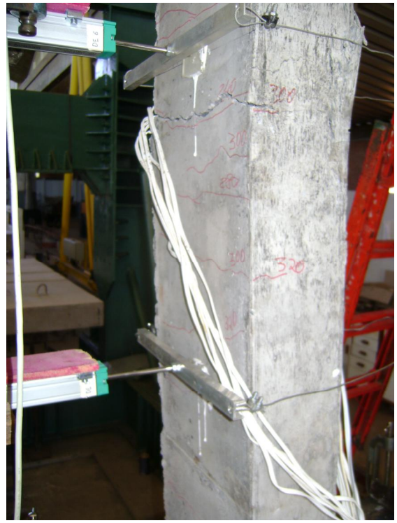
Figura 4.39 – Ruína do pilar PFN 30-2,5
