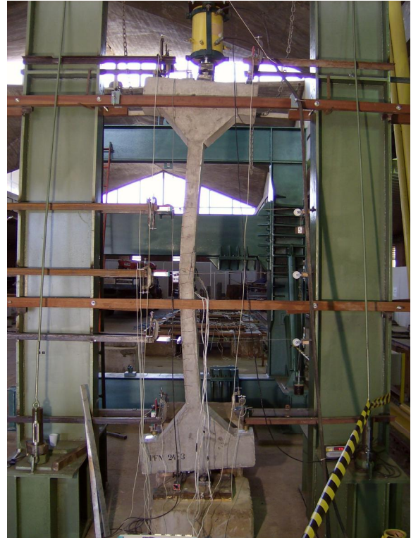
Figura 4.31 – Ruína do pilar PFN 24-3
