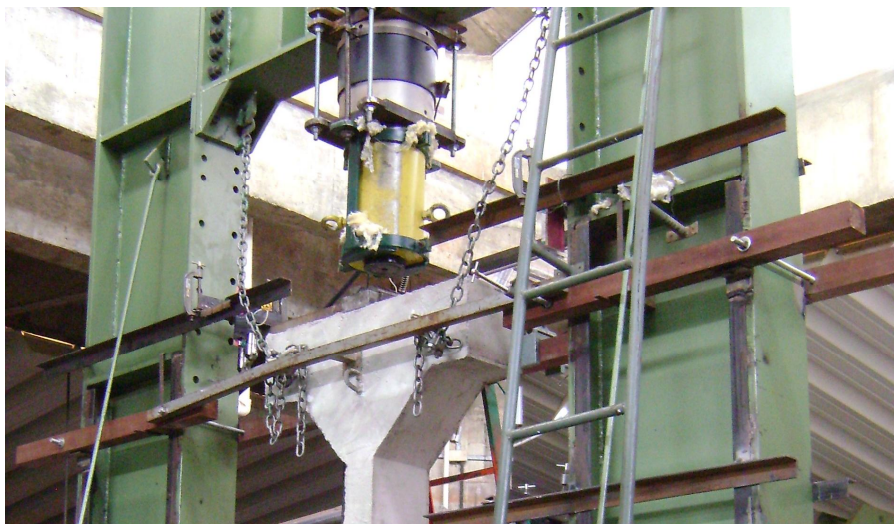
Figura 3.26 – Colocação da haste metálica e correntes de segurança
