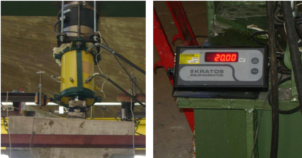
Figura 3.20 – Célula de força em linha com o macaco hidráulico (esq.) e leitor digital (dir.)
