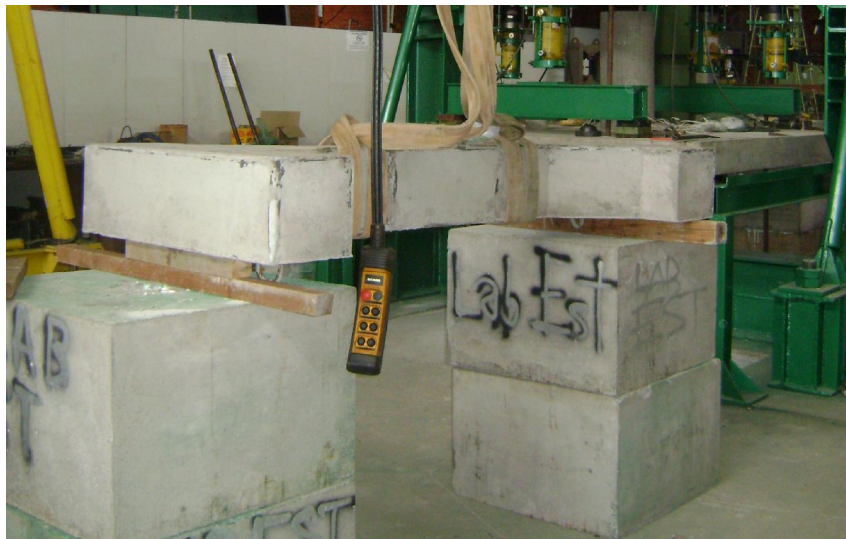
Figura 3.22 – Posicionamento do pilar para a determinação do eixo longitudinal
