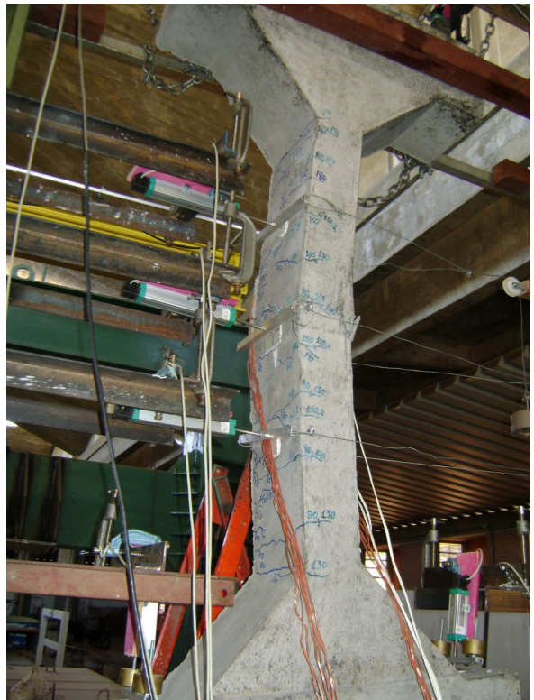
Figura 4.49 – Ruína do pilar PFN 60-2
