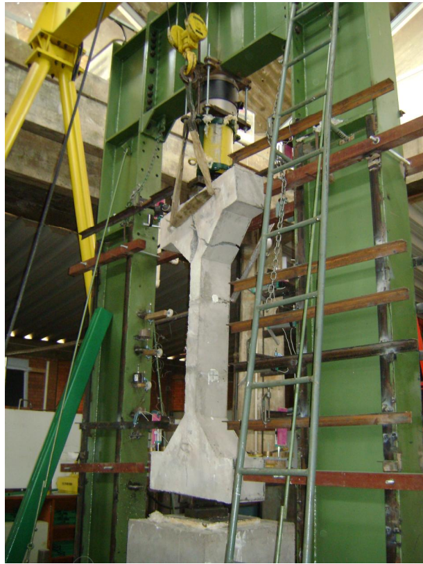
Figura 3.25 – Posicionamento do pilar no pórtico de ensaios
