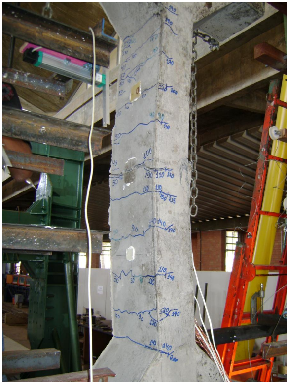
Figura 4.48 – Ruína do pilar PFN 50-2
