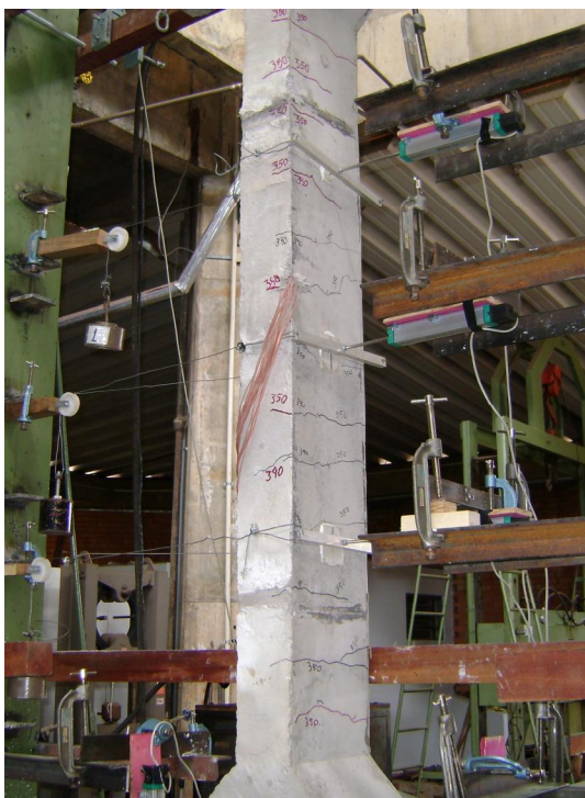
Figura 4.14 – Fissuras do pilar PFN 24-2,5
