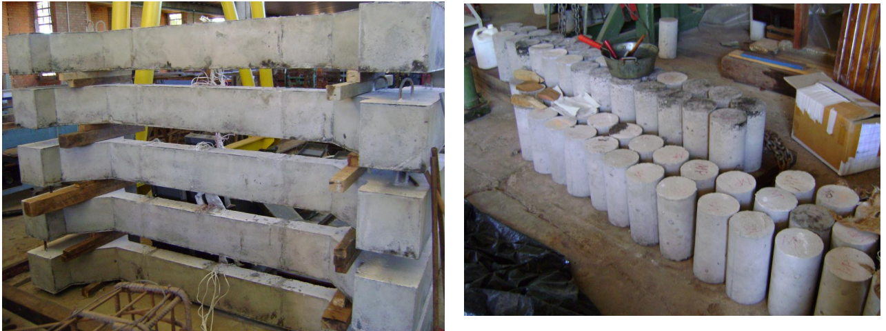
Figura 3.7 – Pilares e corpos-de-prova desmoldados
