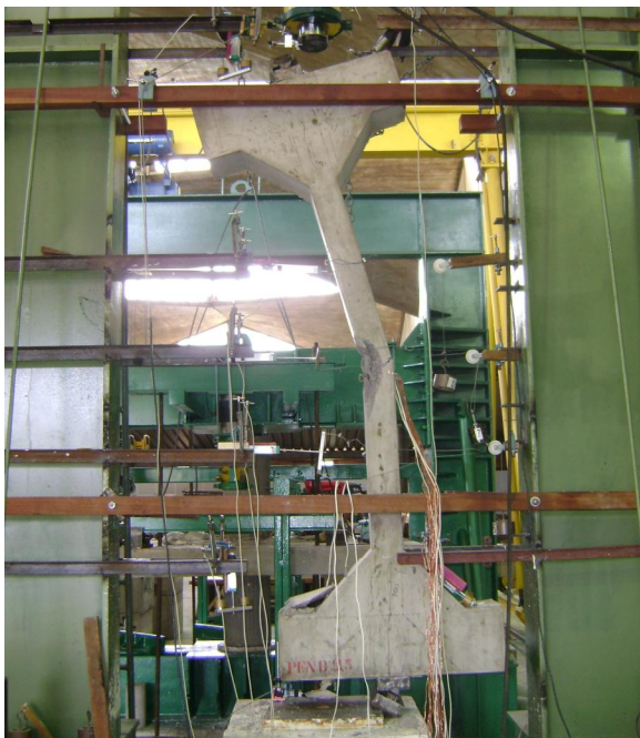
Figura 4.36 – Ruína do pilar PFN 0-2,5
