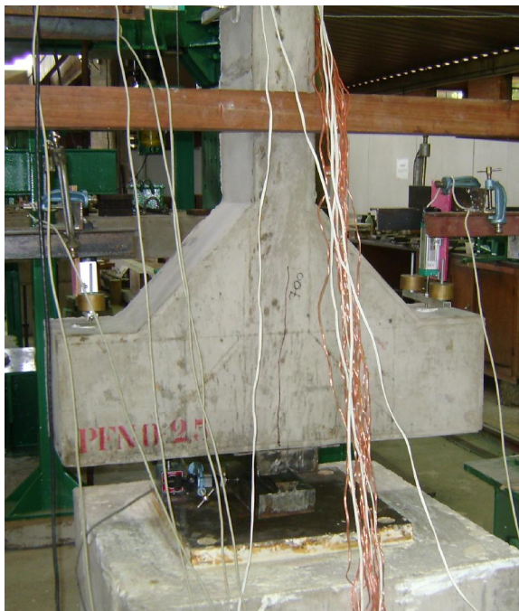
Figura 4.12 – Fissuras do pilar PFN 0-2,5
