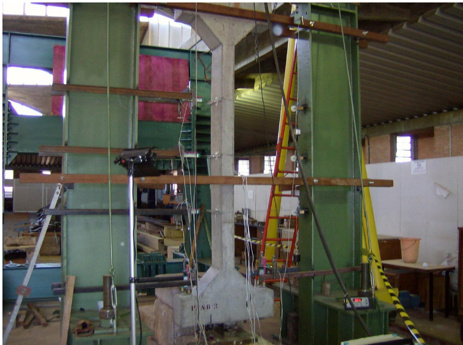
Figura 3.27 – Pilar posicionado no pórtico de reação com a instrumentação
