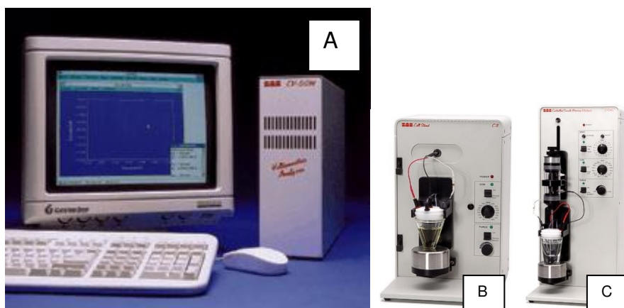
Figura 4.1 - (A) Sistema voltamétrico CV-50W da BAS. (B) Célula para eletrodo sólido. (C) Célula para eletrodo de mercúrio
