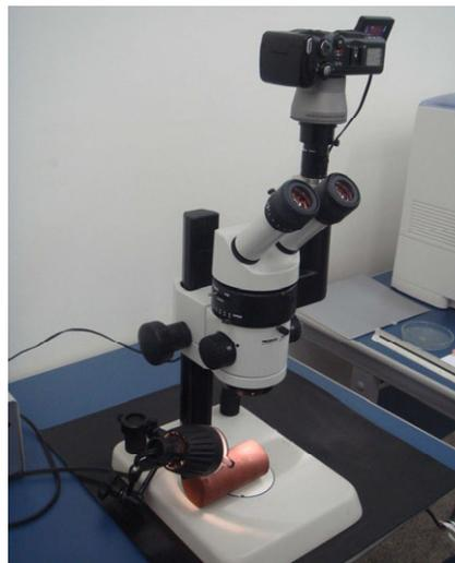
Figura 3.27 - Lupa Binocular Estereoscópica.
