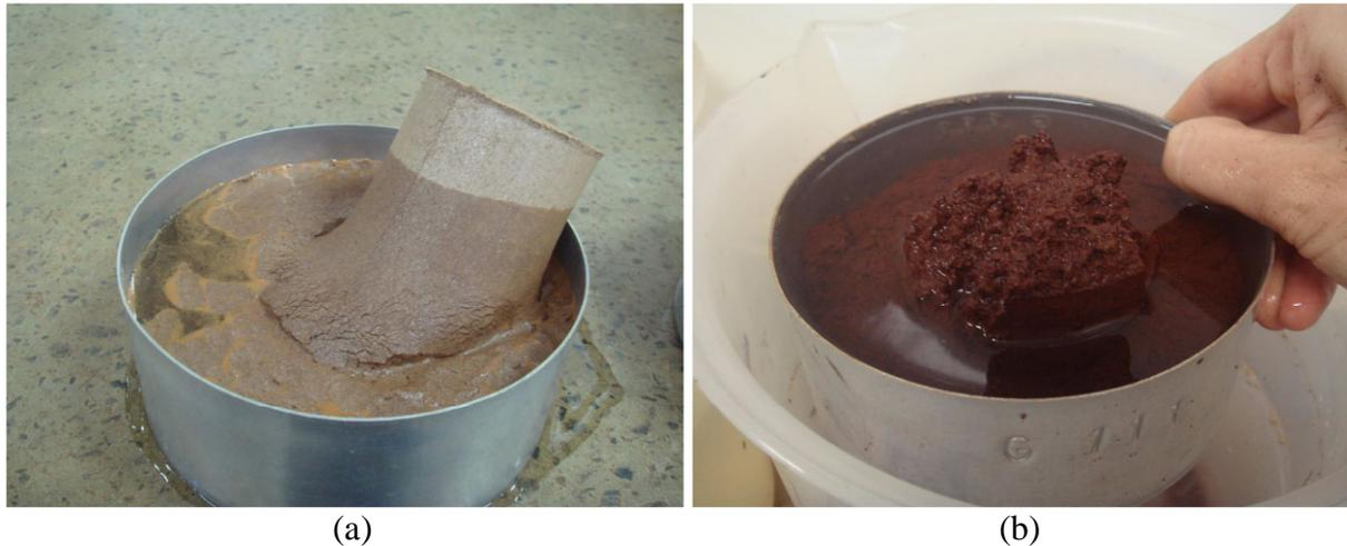
Figura 3.26 – Corpos de Prova após imersão: a) Solo Corumbá sem emulsão; b) Solo Goiânia sem emulsão.
