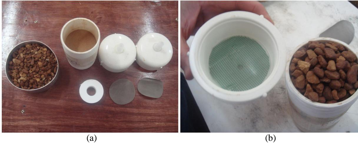
Figura 3.40 - Permeâmetro de PVC: a) Componentes antes da montagem; b) Fechamento do permeâmetro após a colocação do cascalho.
