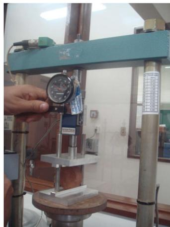
Figura 3.34 - Equipamento utilizado nos ensaios de compressão diametral.
