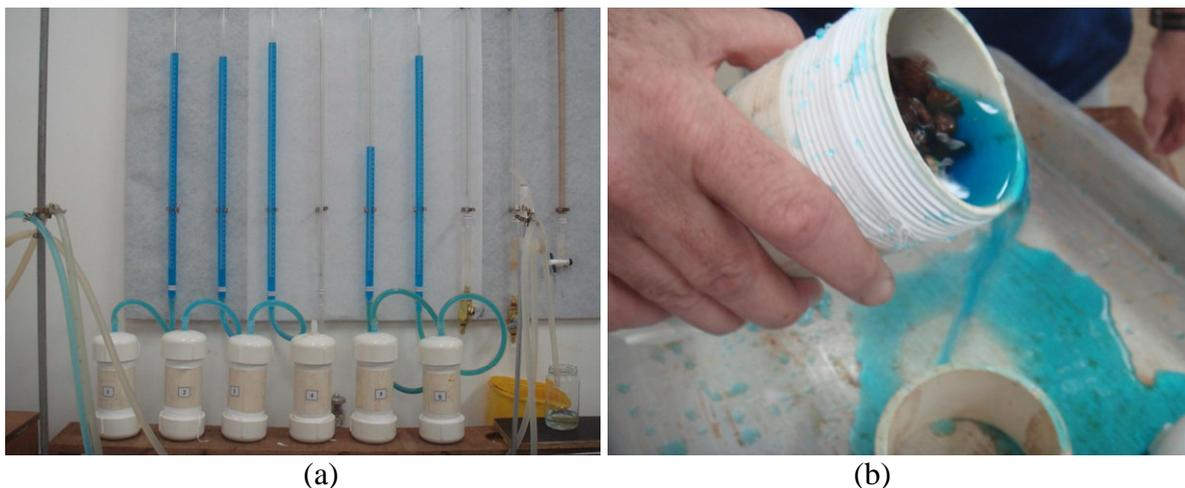
Figura 3.43 - Teste do corante: a) Passagem de água mais corante pelas amostras; b) Abertura do permeâmetro após o teste com corante.
