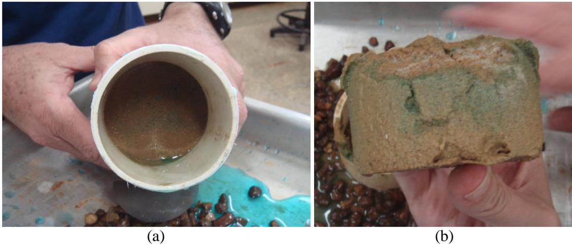
Figura 3.44 - Teste do corante: a) Cor azul no topo da amostra; b) Cor azul indicando fluxo na lateral da amostra.
