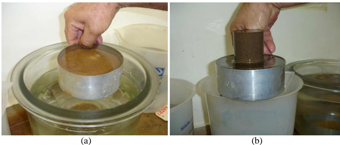
Figura 3.25 - Corpos de Prova após imersão: a) Solo Peixe sem emulsão (totalmente desagregado); b) Solo Peixe com 2% de emulsão.
