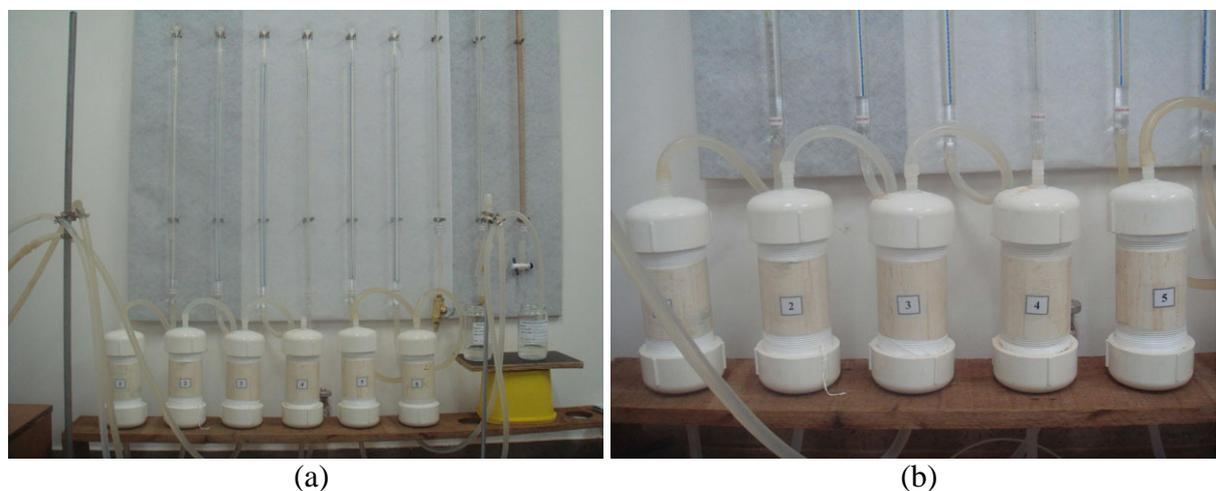
Figura 3.41 - Permeâmetro de PVC: a) Permeâmetros montados e conectados ao quadro de leitura; b) Detalhe dos permeâmetros conectados às buretas.
