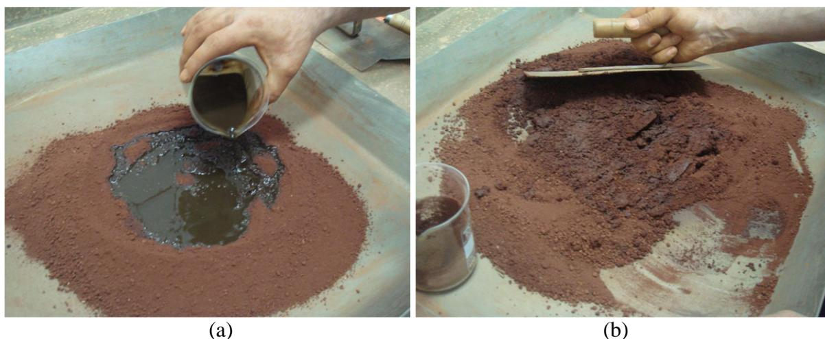
Figura 3.11 - Processo de Mistura: a) Adição da Emulsão diluída em água; b) Mistura da emulsão ao solo.
