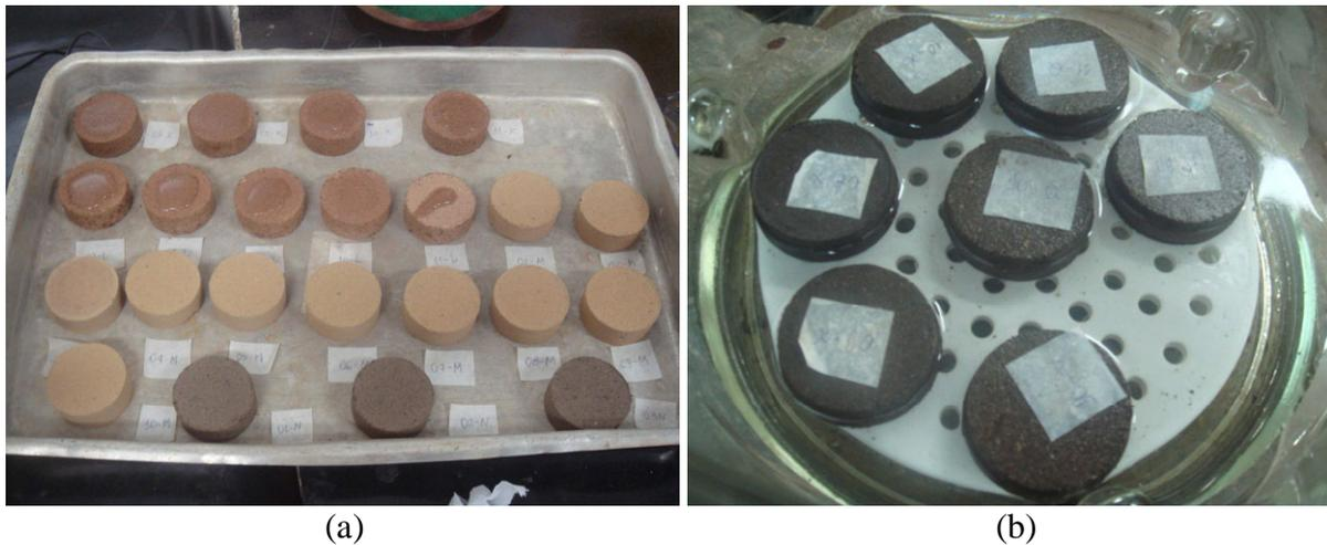
Figura 3.30 - CPs após moldagem: a) Secagem ao ar, b) Umedecimento por imersão.
