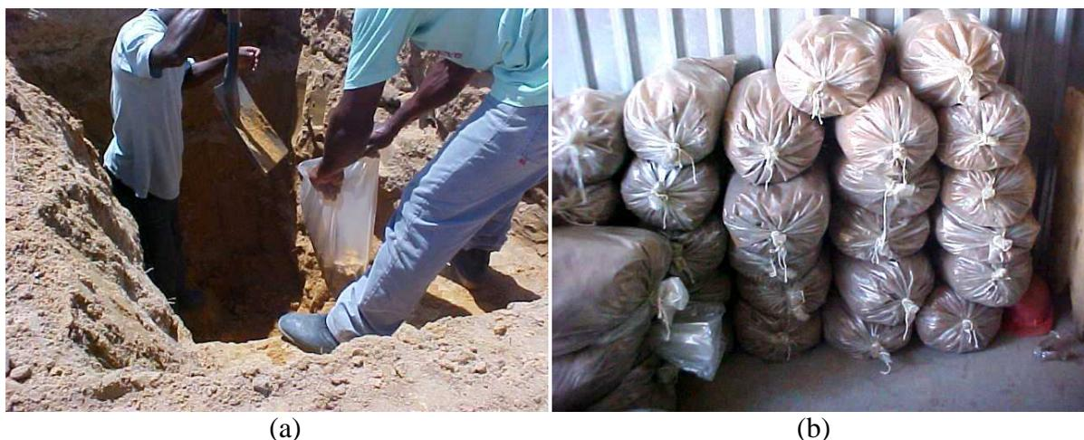
Figura 3.2 - Solo Peixe: a) Coleta da amostra; b) Amostras armazenadas antes do envio.
