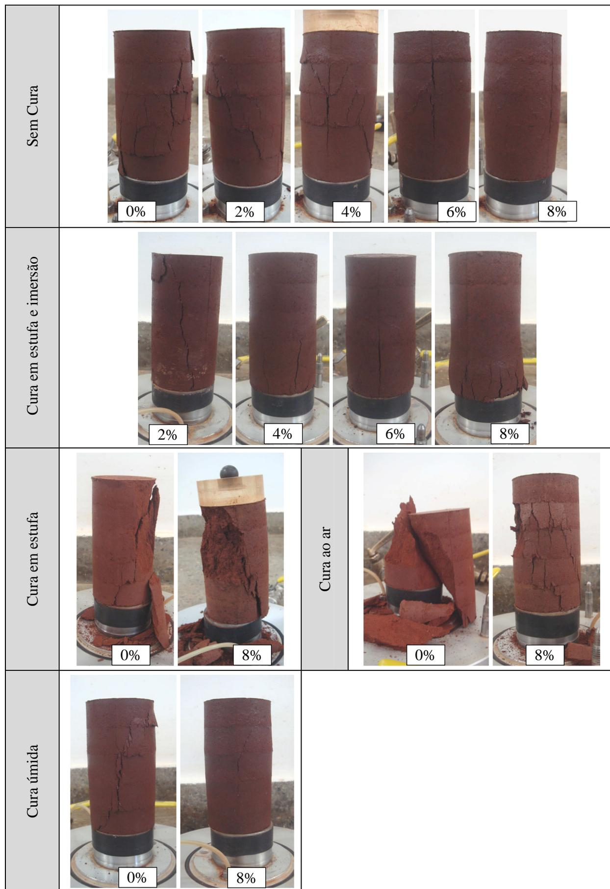
Figura 4.81 - Aspecto dos corpos de prova após a ruptura.
