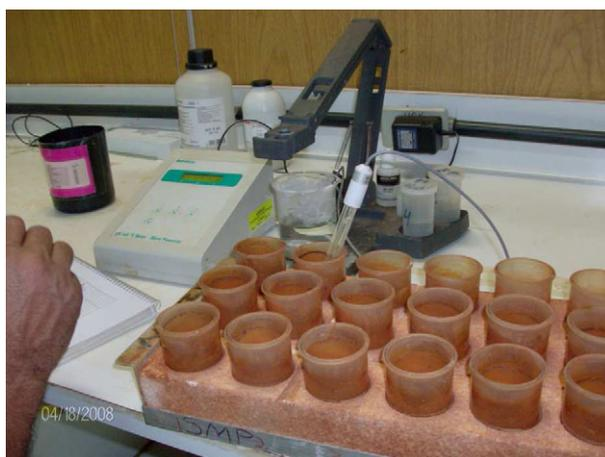
Figura 3.8 - Medição do pH utilizando o potenciômetro (Leite & Brandão, 2008).
