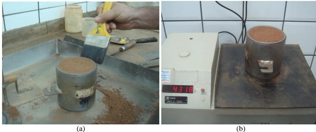
Figura 3.13 - Compactação em cilindro de 4": a) Limpeza dos grãos soltos; b) Determinação da massa de solo mais cilindro.
