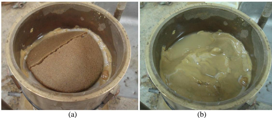
Figura 5.38 - Aspecto do ensaio de permeabilidade: a) A expansão da bentonita causou a quebra da pedra porosa; b) Bentonita encobrindo o corpo de prova;
