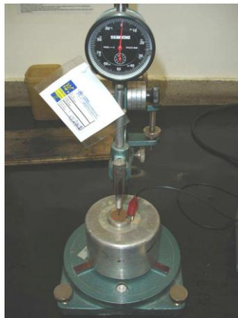
Figura 3.5 - Determinação da Consistência Utilizando o Penetrômetro.
