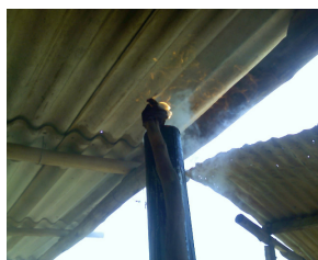
Figura 6.2. Queima da fumaça na saída da chaminé com o auxílio de um queimador.
