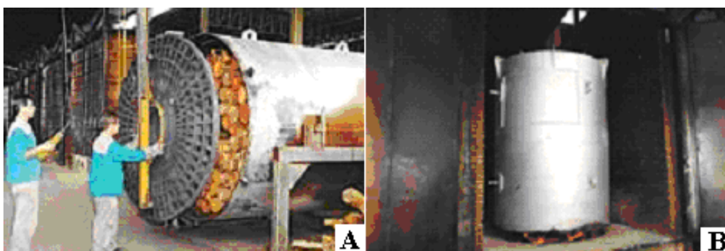
Figura 4.12. Forno cilíndrico metálico (Bricarbrás). (A) Vista da grelha metálica. (B) O cilindro com lenha no forno de carbonização (BRICARBRAS, 2006).
