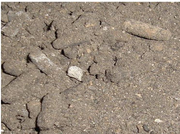
Figura 3.7 - Cinzas resultantes da gaseificação.
