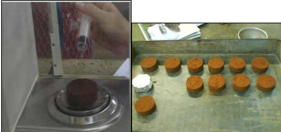
Figura 3.14-Preparação dos corpos de prova umedecimento e secados ao ar
