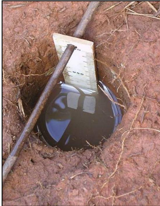
Figura 3.4- Ensaio de rebaixamento em furo de sondagem a trado.
