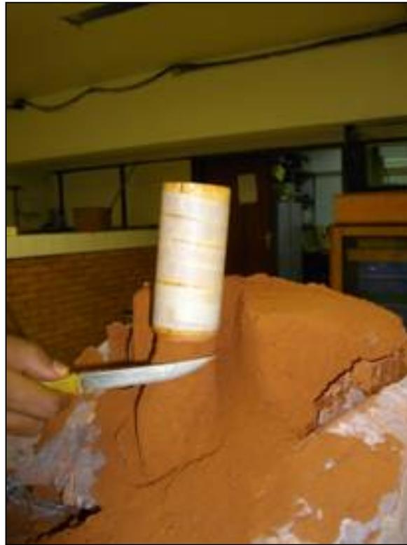
Figura 3.15- Moldagem do corpo de prova,
