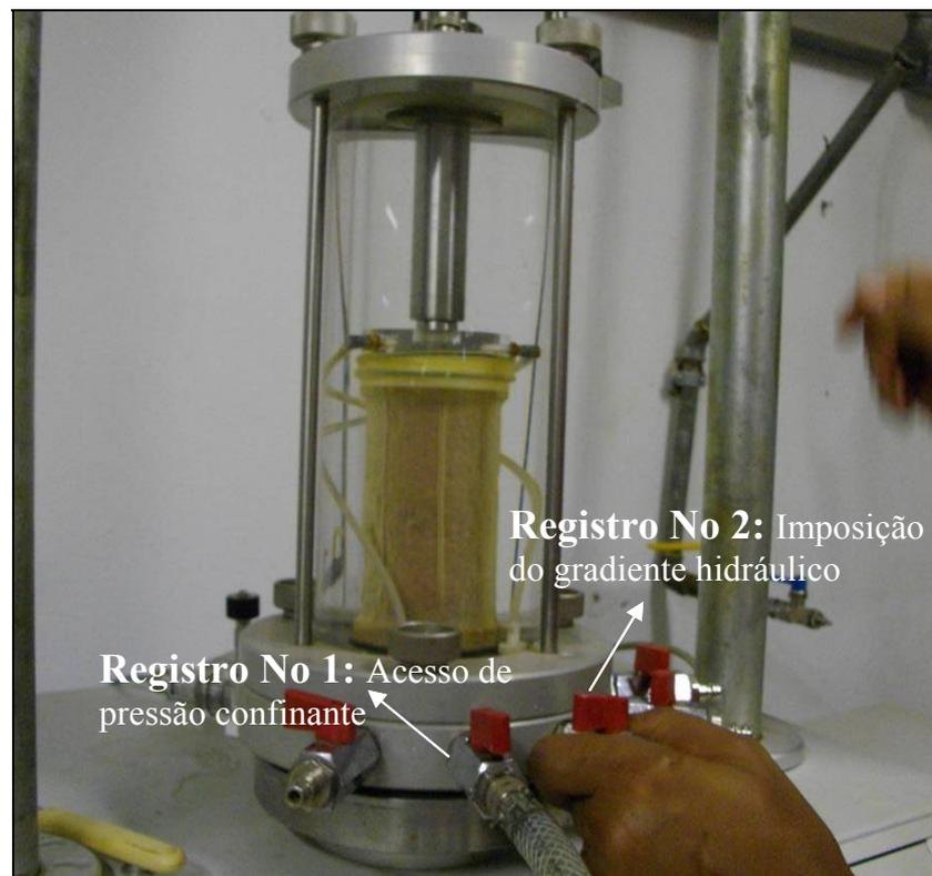
Figura 3.16- Montagem na câmara do triaxial e registros utilizados.
