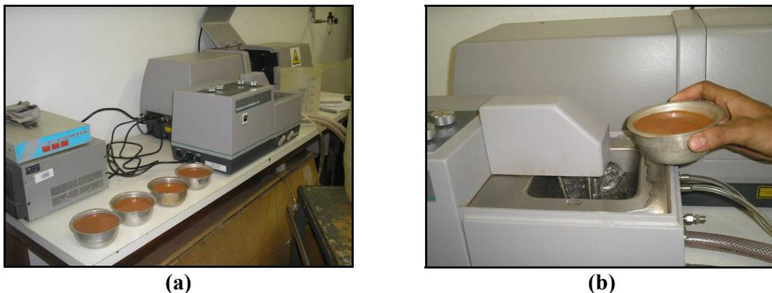
Figura 3.12– (a) - Equipamento Granulômetro da UnB; (b) - Deposição do material para a realização do ensaio.
