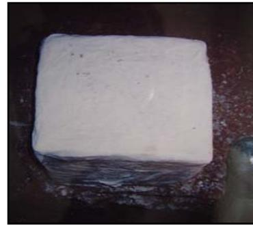
Figura 3.10- Retirada do blocos de amostras indeformadas.
