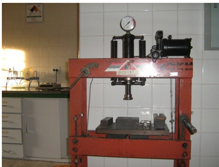
Figura 3.4. Prensa Schulz utilizada para a conformação dos eletrólitos sólidos.
