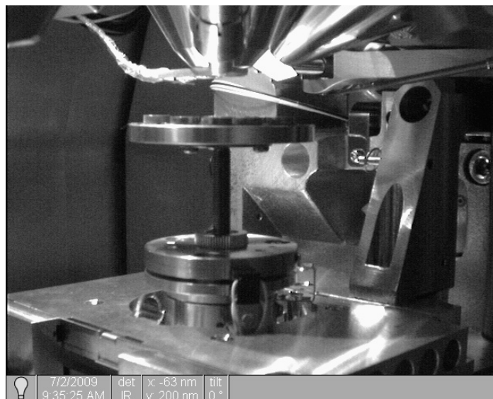
Figura 3.7. Porta mostrador no microscópio eletrônico de varredura.
