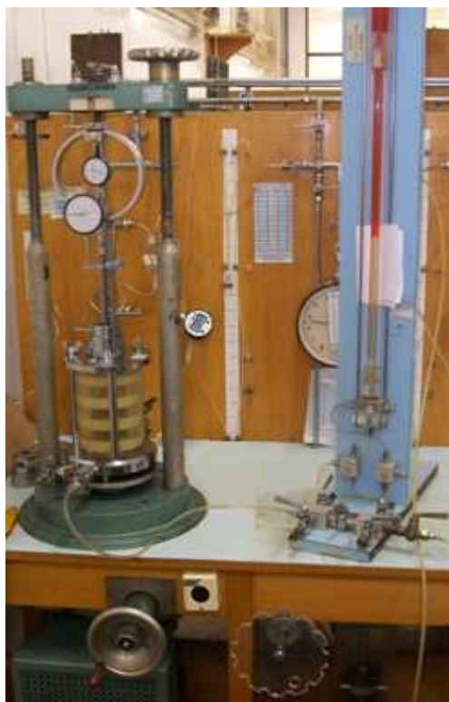
Figura 3.15 Painel utilizado para a realização do ensaio triaxial a diferentes trajetórias.
