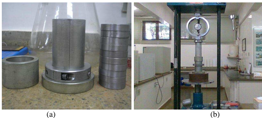
Figura 4.5 Equipamentos utilizados nas moldagens dos corpos de prova: a) Cilindro de moldagem e pastilhas metálicas b) Prensa CBR manual.
