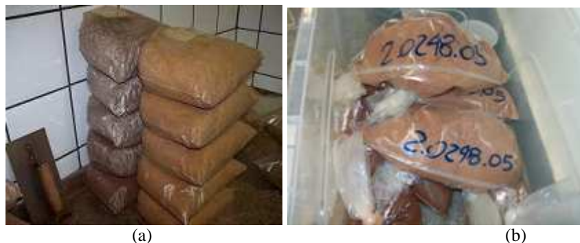
Figura 4.3 Amostras preparadas em repouso: a) Compactação dinâmica b) Compactação semi-estática.
