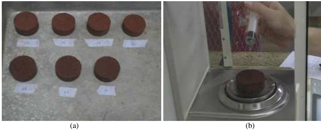
Figura 3.5 Preparação dos corpos de prova para ensaio de papel filtro: a) Secagem ao ar, b) Umedecimento por gotejamento.
