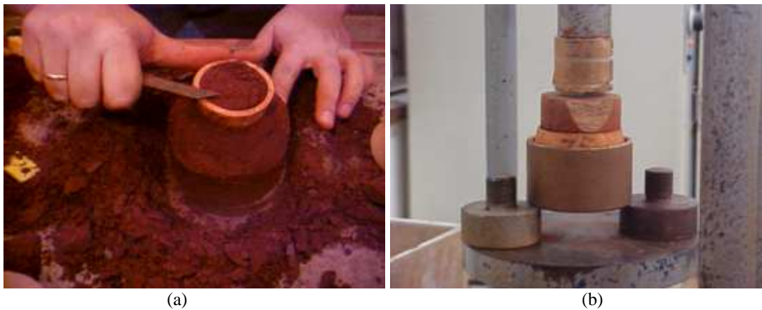
Figura 3.4 Moldagem dos corpos de prova da compactação dinâmica: a) Cravação do cilindro de PVC, b) Desmoldagem dos corpos de prova do cilindro de PVC.
