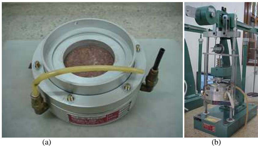
Figura 3.11 Montagem do Ensaio: a) corpo de prova dentro do anel, b) Prensa de adensamento
