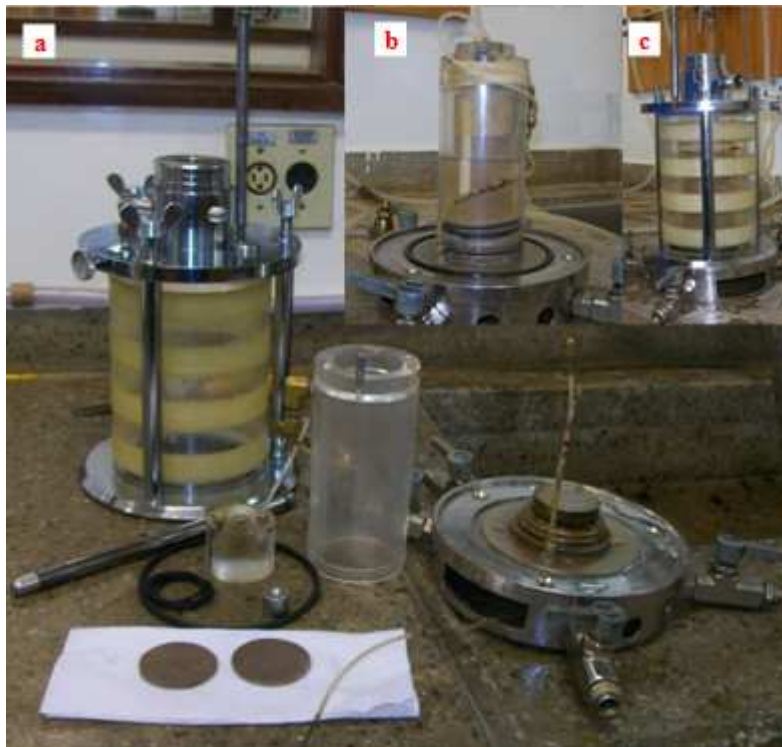
Figura 3.13 Célula triaxial tipo k_0 : a) Partes da célula desmontada, b) Célula interna montada, c) Célula completamente montada.
