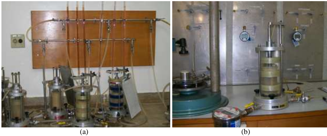
Figura 3.12 Saturação dos corpos de prova: a) Saturação por percolação ascendente, b) Aplicação de contra-pressão.
