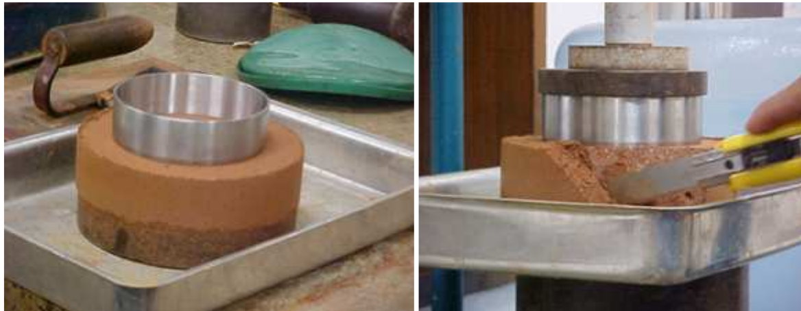
Figura 3.10 Moldagem do corpo de prova: a) Anel de adensamento e corpo de prova compactado, b) Cravação do anel no corpo de prova.
