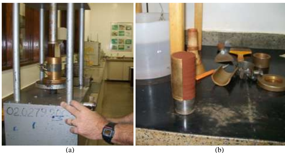
Figura 4.6 Moldagem dos corpos-de-prova: a) Prensa, b) Corpo de prova compactado.
