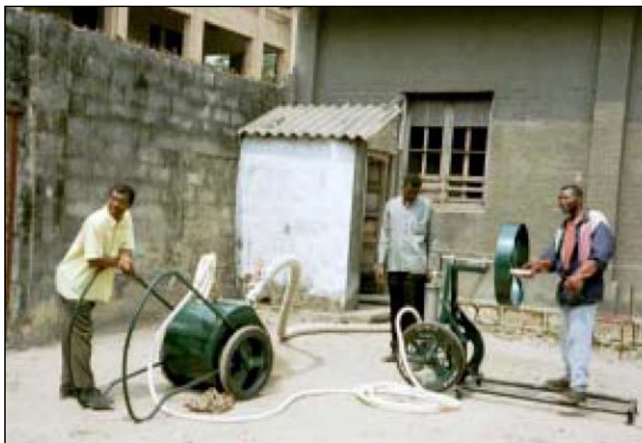
Figura 5.6 – Coleta do lodo utilizando equipamento de bombeamento movido manualmente (Klingel et al. , 2002)
