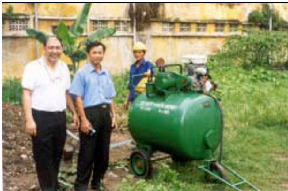
Figura 5.5 – Tanque de sucção de pequeno porte com bombeamento mecânico (Klingel et al. , 2002)
