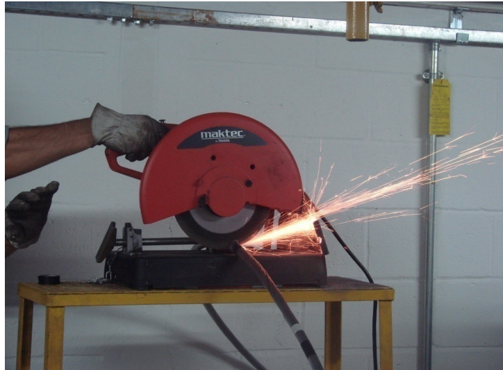
Figura 3.22 - Corte do corpo de prova utilizando-se disco de corte
