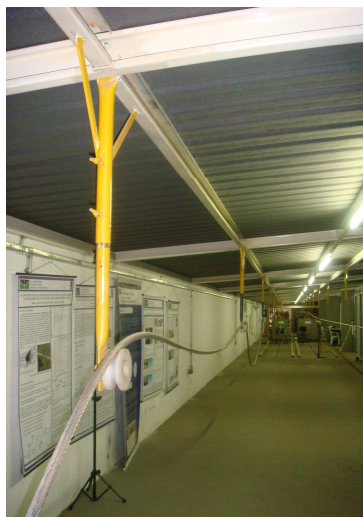
Figura 3.21 - Polias auxiliares posicionadas ao longo do vão do teste
