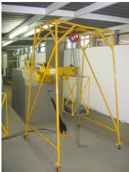
Figura 3.10 – Bloco fixo 3 que contém os equipamentos para controle de tração do cabo
