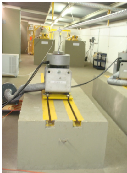
Figura 3.9 – Bloco fixo com o trilho para deslocamento do shaker
