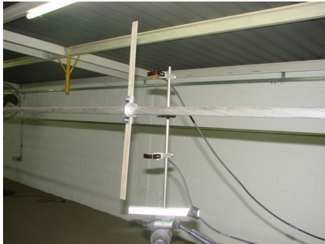
Figura 3.18- Dispositivo de detecção de quebra de fios
