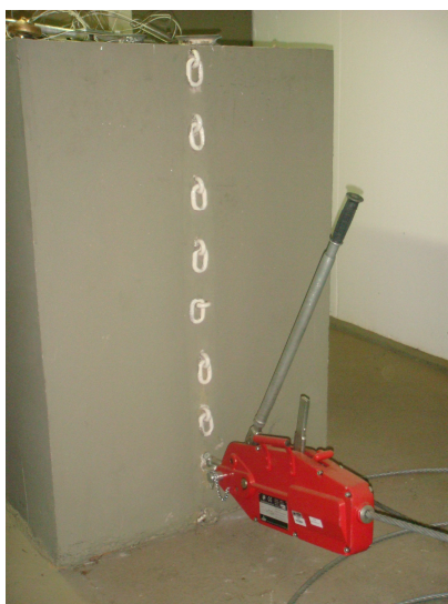
Figura 3.11 - Talha de alavanca ancorada ao bloco de fixação 1
