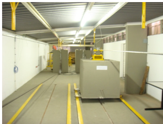
Figura 3.8 – Bloco móvel montado em uma base com rolamentos e os trilhos
