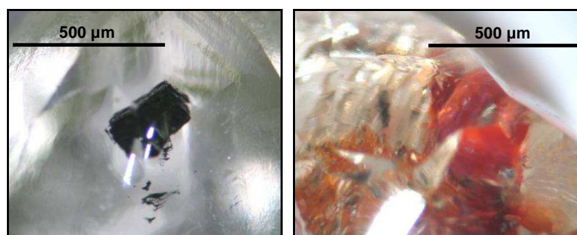
Figura 2.5 – Inclusões pretas tabulares (esquerda) e de cores variadas com aspecto de percolação (direita).
