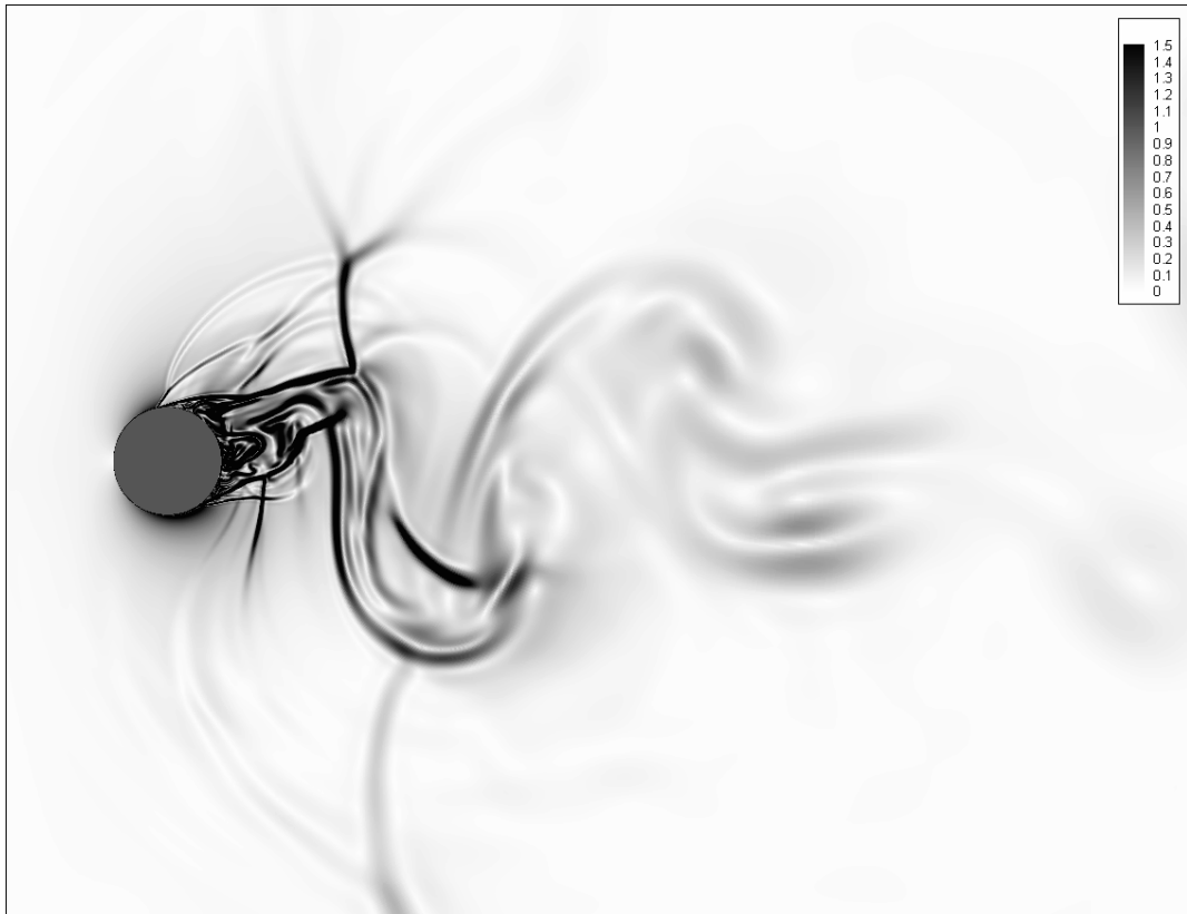
Figura 3.55: Campo de gradiente de temperatura, tempo adimensional t = 130,14U^*/D^* ( M=0,8 , Re=500.000 ).
