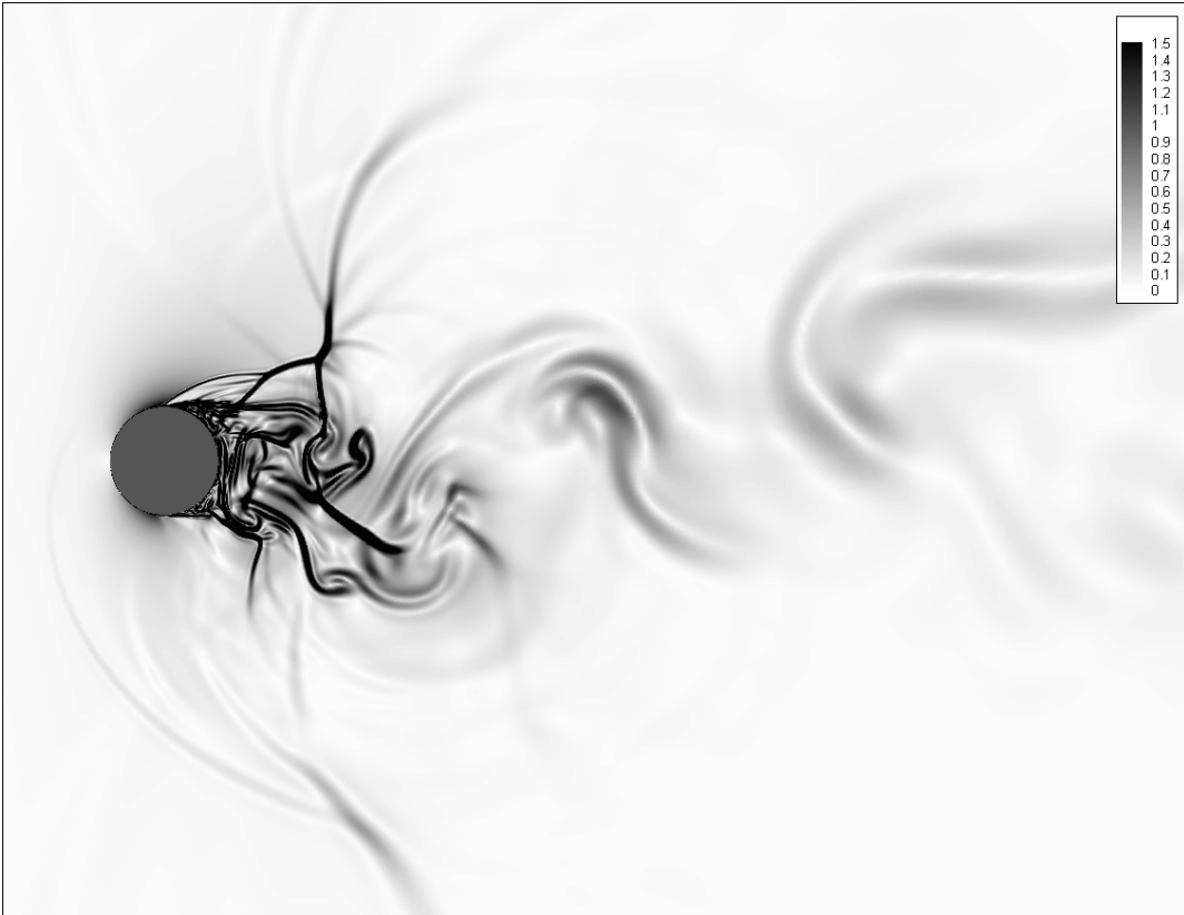
Figura 3.35: Campo de gradiente de temperatura, tempo adimensional t = 71,15U^*/D^* ( M=0,8 , Re=166.000 ).
