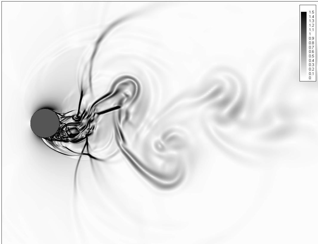
Figura 3.37: Campo de gradiente de temperatura, tempo adimensional t = 73,77U^*/D^* (M=0,8, Re=166.000).
