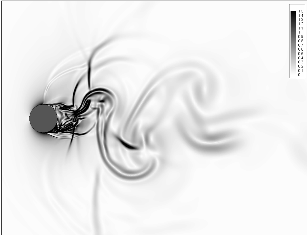
Figura 3.56: Campo de gradiente de temperatura, tempo adimensional t = 130,85U^*/D^* ( M=0,8 , Re=500.000 ).
