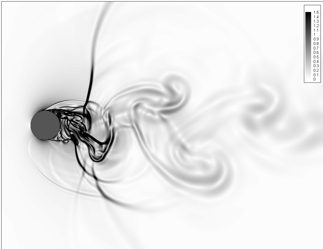
Figura 3.38: Campo de gradiente de temperatura, tempo adimensional t = 75,06U^*/D^* ( M=0,8 , Re=166.000 ).
