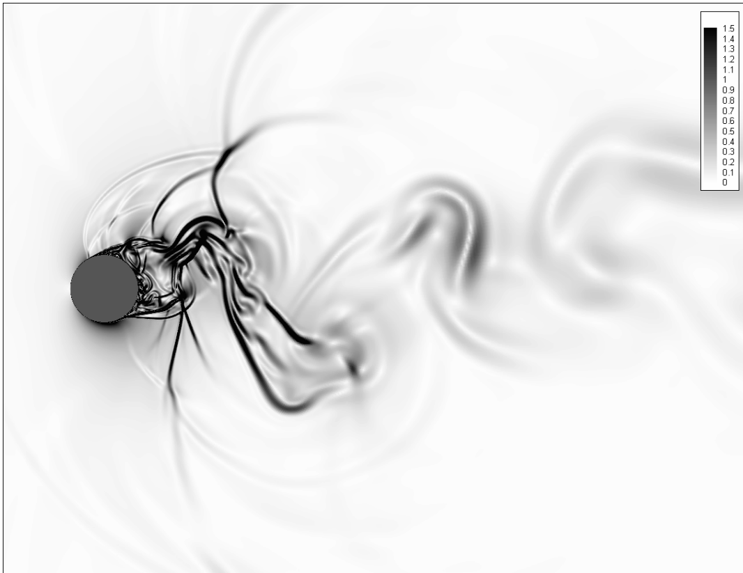
Figura 3.36: Campo de gradiente de temperatura, tempo adimensional t = 72,45U^*/D^* (M=0,8, Re=166.000).
