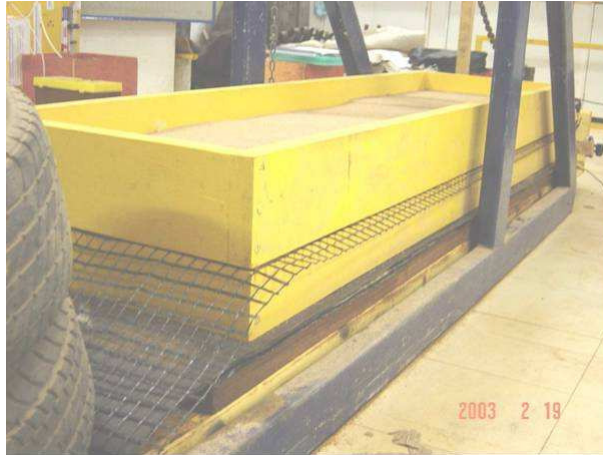
Figura A.1 – Execução do ensaio de plano inclinado com elevação da posição da geogrelha: rampa na horizontal.
