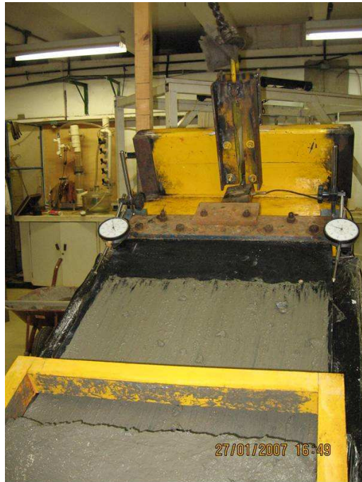
Figura A.19 – Execução do ensaio com concreto fresco no equipamento de plano inclinado: detalhe da aderência do concreto na geomembrana.
