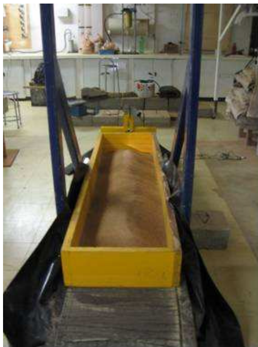
Figura A.9 – Execução da preparação do ensaio com GCL's hidratados no equipamento de plano inclinado: colocação do solo de cobertura na caixa de confinamento.
