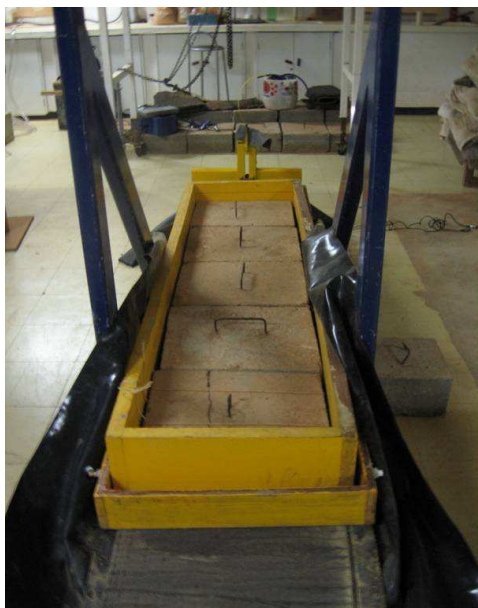
Figura A.11 – Execução da preparação do ensaio com GCL's hidratados no equipamento de plano inclinado: aplicação de sobrecarga.
