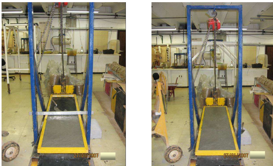
Figura 4.6 – Seqüência do preenchimento da caixa de confinamento com concreto fresco.
