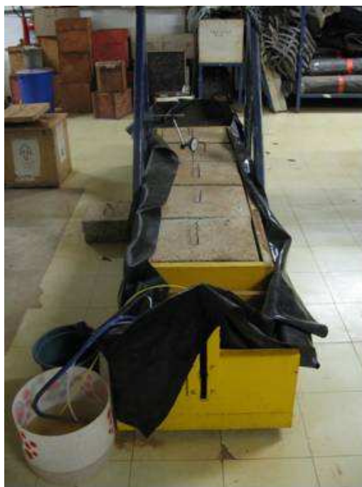
Figura A.14 – Execução da preparação do ensaio com GCL's hidratados no equipamento de plano inclinado: remoção da água do reservatório.
