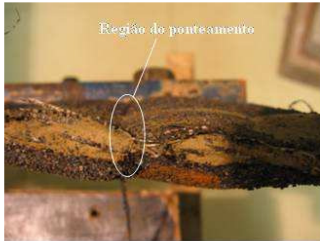
Figura 6.13 – Forma deformada da GCL-B após expansão.
