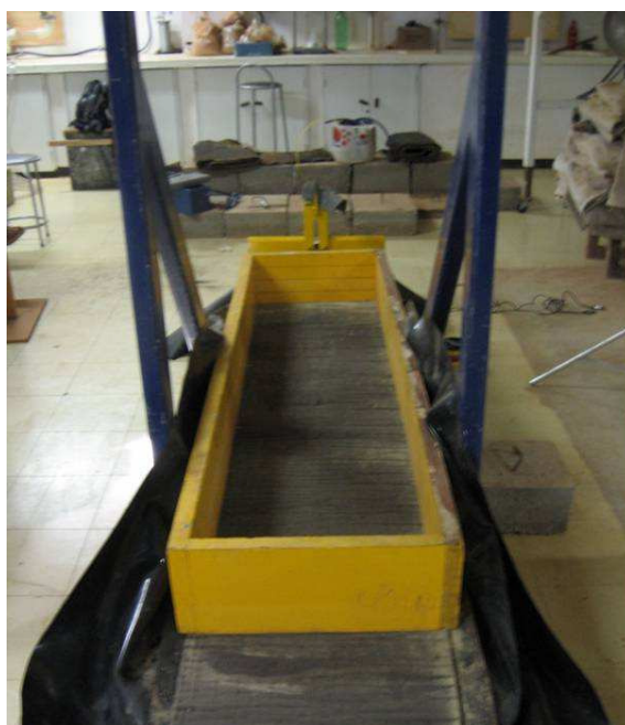
Figura A.8 – Execução da preparação do ensaio com GCL's hidratados no equipamento de plano inclinado: colocação da caixa de confinamento.
