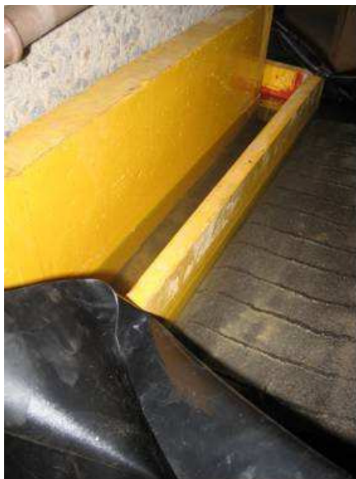
Figura A.13 – Execução da preparação do ensaio com GCL's hidratados no equipamento de plano inclinado: detalhe da lâmina d'água.
