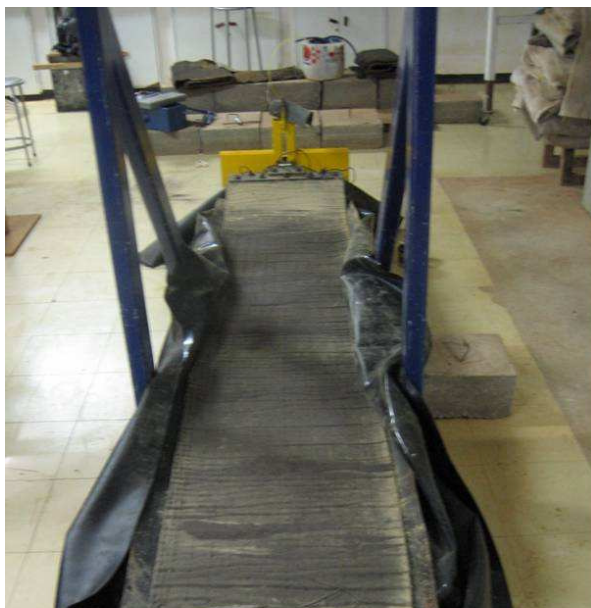
Figura A.7 – Execução da preparação do ensaio com GCL's hidratados no equipamento de plano inclinado: colocação do GCL sobre a geomembrana.
