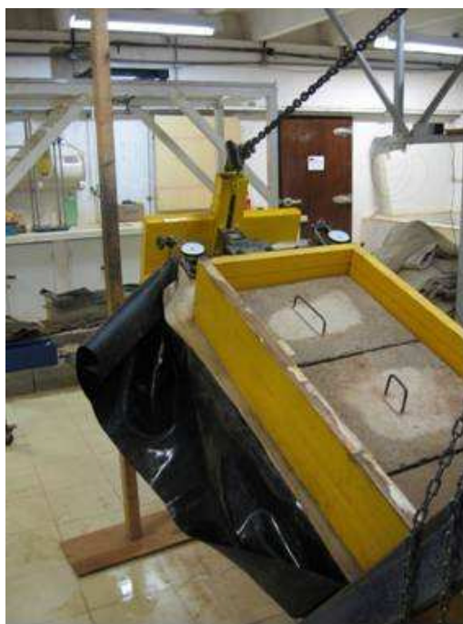
Figura A.15 – Execução do ensaio com GCL's hidratados no equipamento de plano inclinado pós-remoção da água do reservatório.
