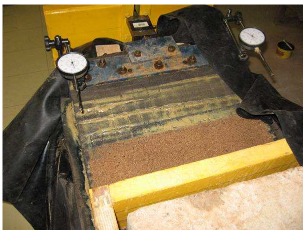
Figura A.16 – Execução do ensaio com GCL's hidratados no equipamento de plano inclinado: situação pós-ruptura.
