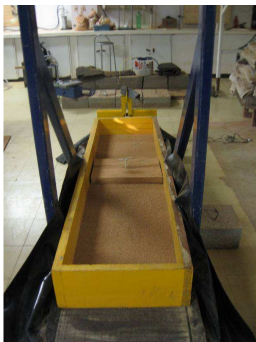
Figura A.10 – Execução da preparação do ensaio com GCL's hidratados no equipamento de plano inclinado: nivelamento e compactação do solo de cobertura.
