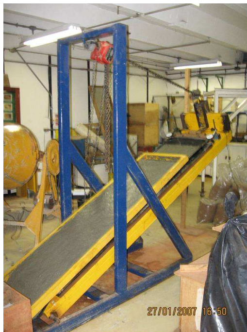
Figura A.18 – Execução do ensaio com concreto fresco no equipamento de plano inclinado: ruptura.
