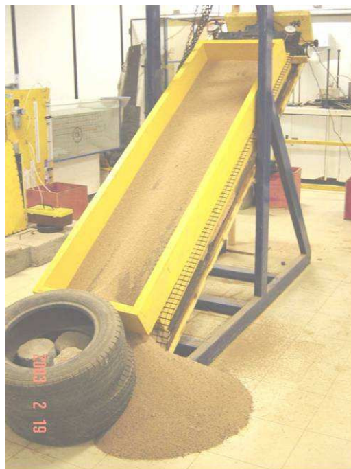
Figura A.4 – Execução do ensaio de plano inclinado com elevação da posição da geogrelha: ruptura.
