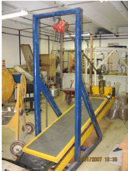
Figura A.17 – Execução do ensaio com concreto fresco no equipamento de plano inclinado: levantamento da rampa.
