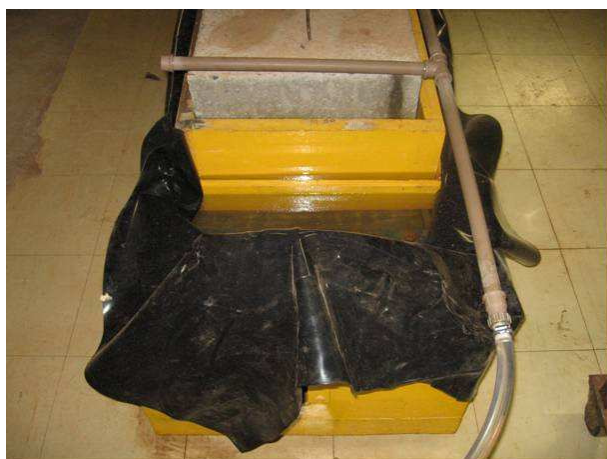
Figura A.12 – Execução da preparação do ensaio com GCL's hidratados no equipamento de plano inclinado: montagem do reservatório e introdução de água no sistema.
