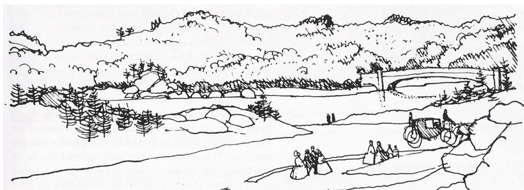
**Figura 2.5:** Separação de vias e introdução de pontes nas intersecções para evitar conflitos entre tráfego de veículos (motorizados e de tração animal) e pedestres.
