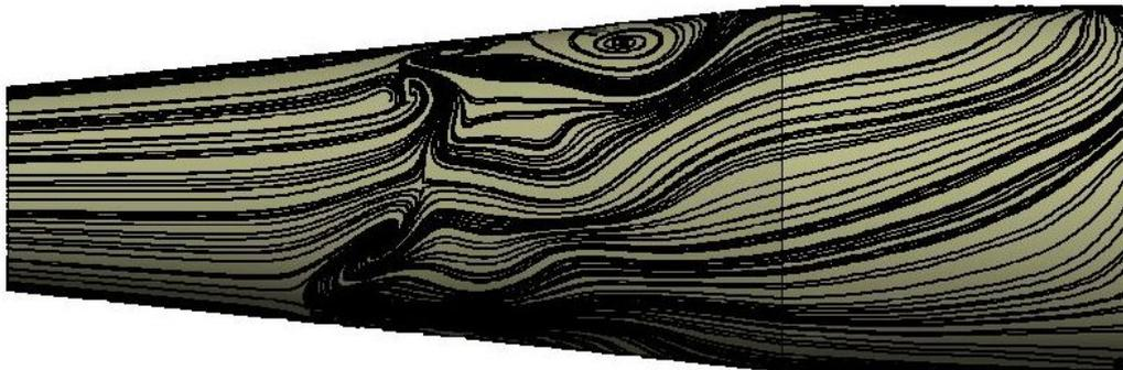
Figura 5.14: Linhas de cisalhamento nas paredes do difusor com  $2\theta = 12^\circ$ .
