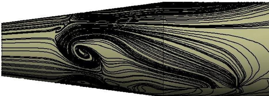
Figura 5.15: Linhas de cisalhamento nas paredes do difusor com  $2\theta = 15^\circ$ .
