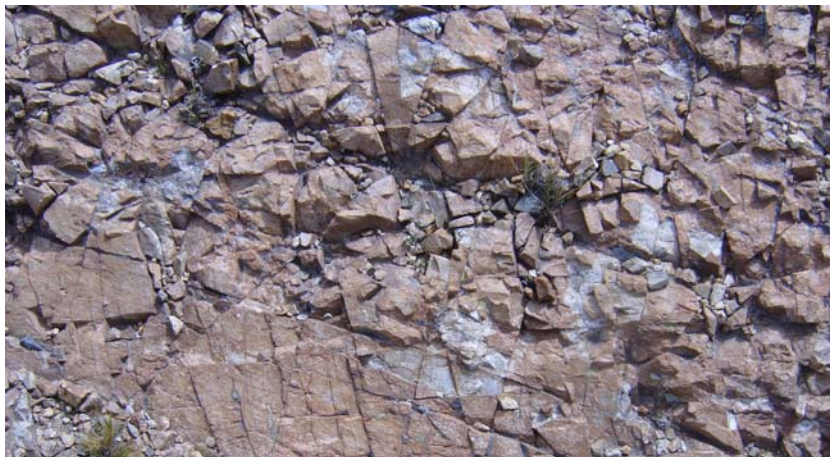
Figura 2.5: Exemplo do intenso fraturamento do quartzo–arenito da Formação Soraya (foto da encosta NW do Cerro Condorsayana)
