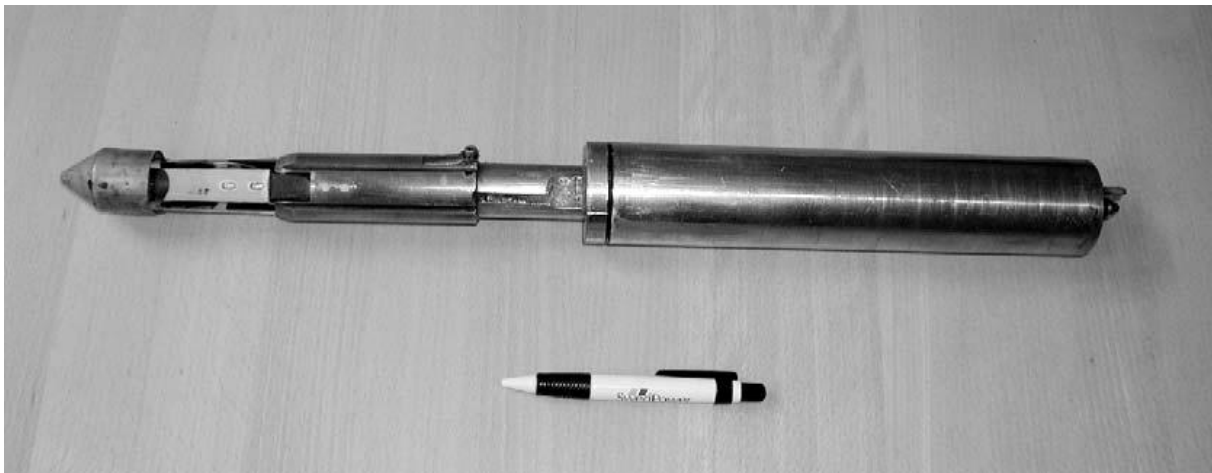
Figura 2.20 - Sonda Borre utilizada no método de overcoring (Sjoberg & Klasson, 2003).
