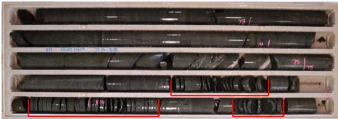
Figura 2.31 - Exemplo de caixa de testemunhos com ocorrência de discings em mina de Bench Stopping (Bustos & Villaescusa, 2024).
