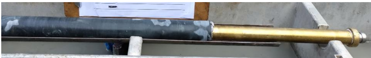
Figura 2.24 - Ferramenta IST3D no testemunho após o overcoring (Gray e Keloth, 2025).
