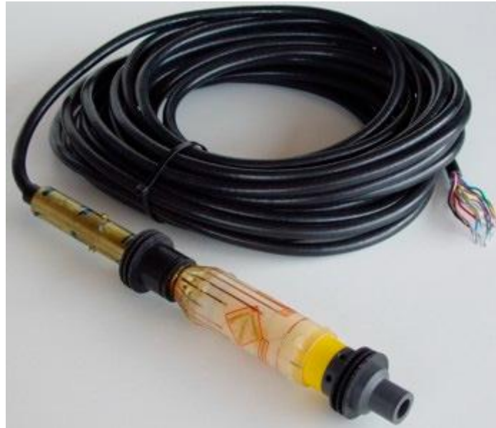
Figura 2.19 - Sonda de ensaio CSIRO HI (Adach-Pawelus & Pawelus, 2021)
