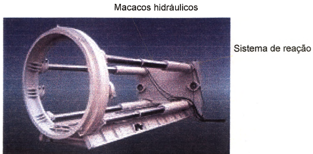
Figura 2.5 - Sistema de avanço através de macacos hidráulicos de uma escavação mecanizada pertencentes a um shield de escavação subterrânea.
