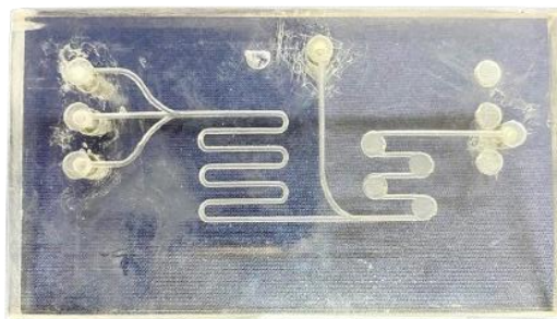
Figura 19 – Chip microfluídico construído por usinagem em Router CNC
