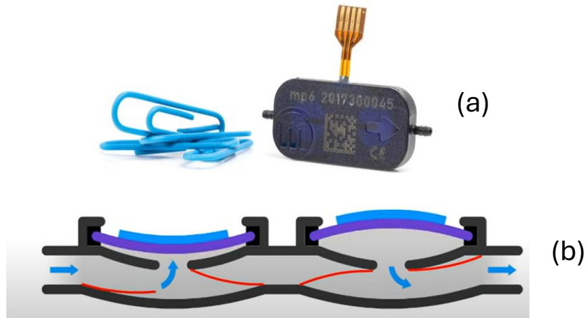
Figura 2 – (a) Bombas Piezoelétricas. Modelo mp6 Bartels. (b) mecanismo de deformação do diafragma para fluxo.
