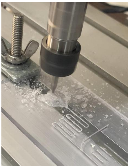
Figura 27 – Processo de usinagem do chip microfluídico. Representando o momento de gravação dos canais por fresa e solução água e sabão sobre o substrato polimérico.
