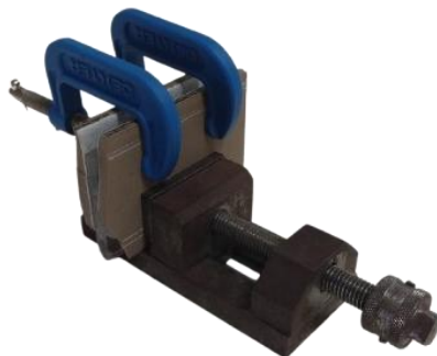
Figura 11 - Morsa abarcando duas placas de vidro, o substrato e a cobertura para a selagem.
