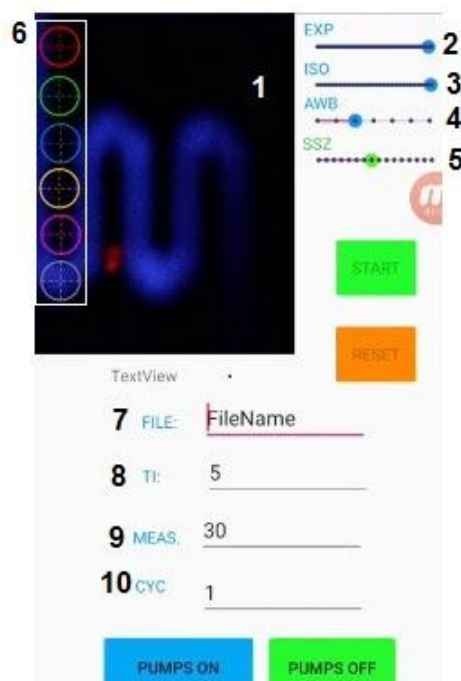
Figura 22 - Tela de ajustes. (1) Tela de detecção em tempo real, (2) controle de exposição, (3) controle de sensibilidade a luz, (4) controle de branco, (5) controle de ajuste do tamanho dos amostradores, (6) amostradores RGB, (7) nome do arquivo, (8) número de injeções por segundo, (9) número de medidas, (10) número de ciclos, botões para condicionamento do sistema “ pumps on ” e “ pumps off ”, iniciar e finalizar medidas “ start ” e “ reset ”.
