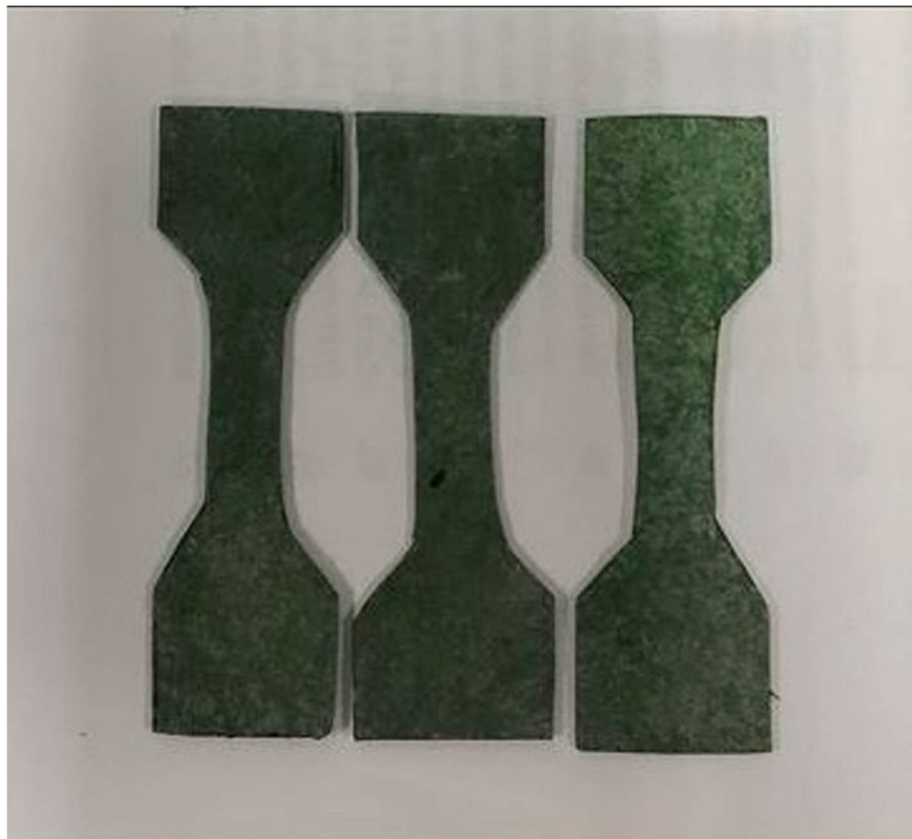
Figura 8 - Corpos de prova do tipo 2 utilizados nos ensaios de tração, orientados paralelamente ao sentido de laminação.
