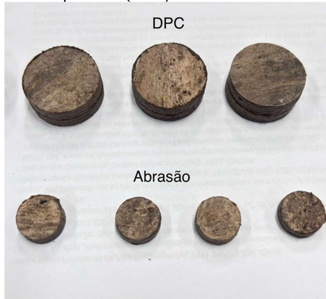
Figura 7 - Corpos de prova utilizados nos ensaios de resistência à abrasão e de deformação permanente à compressão (DPC).
