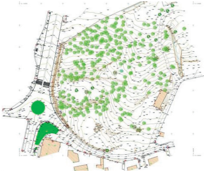
Figura 10 – Exemplo de projeto de levantamento topográfico com mapeamento de vegetação
